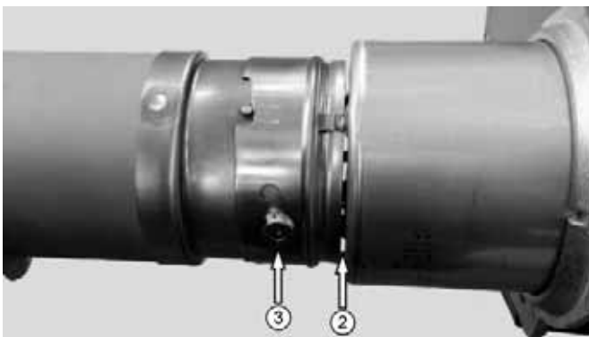
Abb. 4: Einstellung Rezirkulationsmaß R ② (Abbildung beispielhaft)
