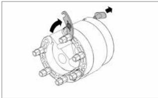
Schnellverschluß und gegenüberliegenden Stift herausziehen, Dichtungseinsatz auseinanderklappen und um die Leitungen legen. Schnellverschluß verschließen. Stift wieder einsetzen.
