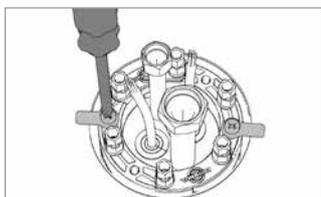
Bei der Montage in einem Quadro-Secura® ADS Rohbauteil sind vor dem Einsetzen die Fixierlaschen mittels handelsüblichen Schraubendreher auf den Gestellring aufzuschrauben.
