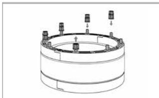
Bereits getrennte Muttern wechselweise über Kreuz in mehreren Intervallen entfernen. Neue Muttern verwenden (optional lieferbar) und Montage wie unter 4 fortsetzen, oder ...
