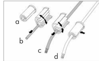
Aus den Zwiebelring (a) den Stopfen (b) entfernen und den Zwiebelringeinsatz um das Kabel/Rohr klappen (c). Dabei so viele Lagen durch Herausreißen entfernen bis sich die Teilungsschnittflächen des Zwiebelringeinsatzes beim Umschließen des Kabels/Rohres berühren aber nicht überlappen (d).
