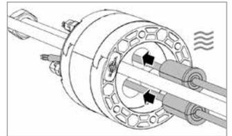
Zwiebelringeinsätze von der wasserzugewandten (!) Seite aus in den Dichtungseinsatz schieben.
