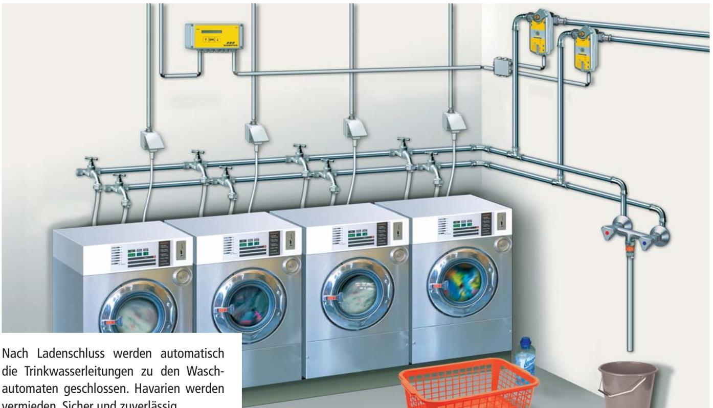
Nach Ladenschluss werden automatisch die Trinkwasserleitungen zu den Waschautomaten geschlossen. Havarien werden vermieden. Sicher und zuverlässig.
