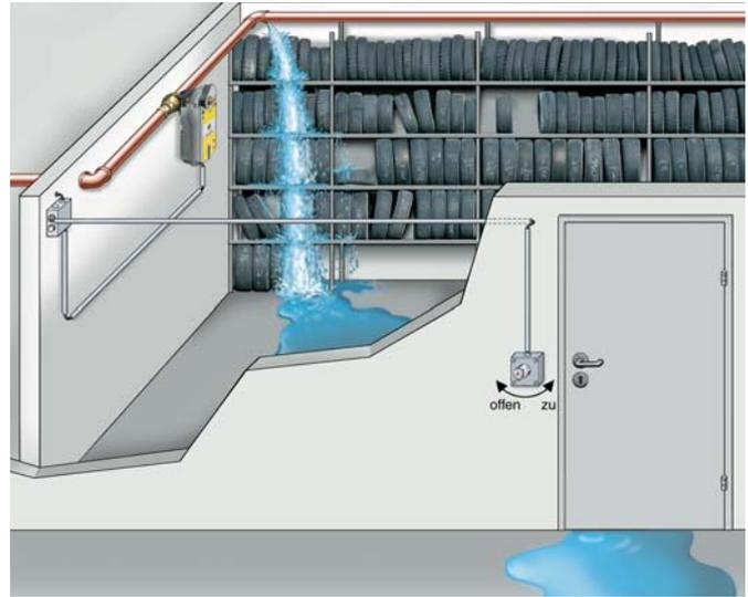
Absperrung des KHS-VAV-plus bei verschlossener Tür mittels Schlüsseltaster.
