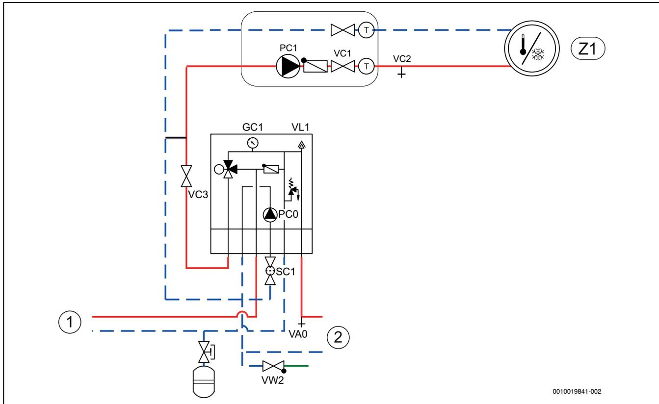
Bild 9 Inneneinheit mit externem Zuheizter und Heizsystem
