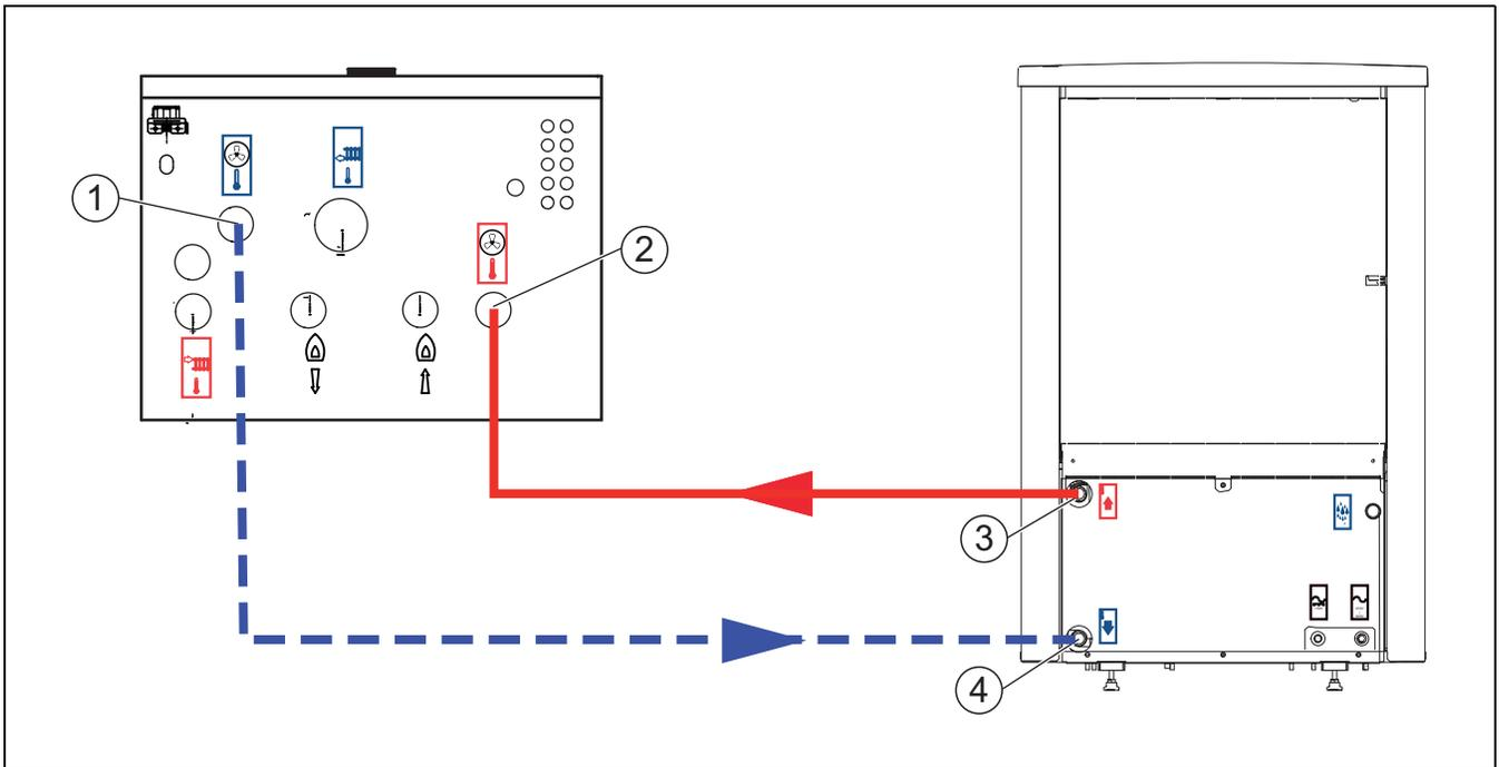
Bild 7 Anschluss der Inneneinheit an die Wärmepumpe
