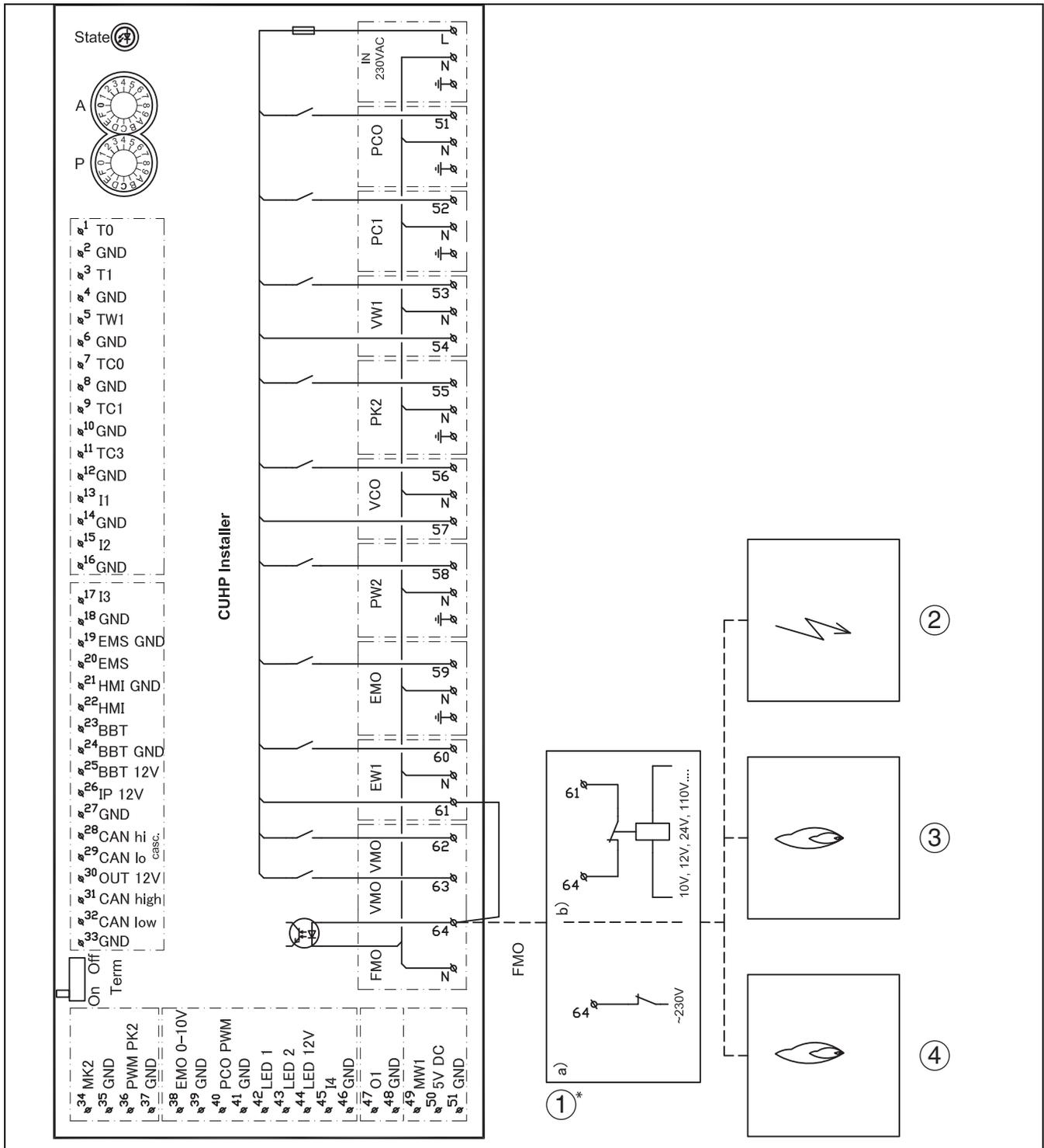
Bild 35 Schaltplan für Installationsmodul, Alarm des externen Zuheizers
