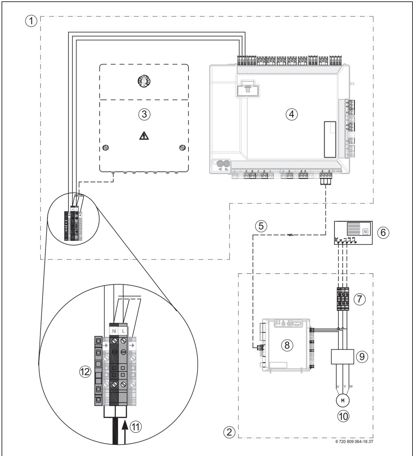
Bild 31 Einphasige Wärmepumpe und Inneneinheit mit externem Zuheizier
