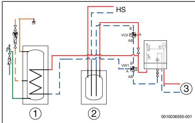
Bild 26 Puffer, VCO-Bypassventil
