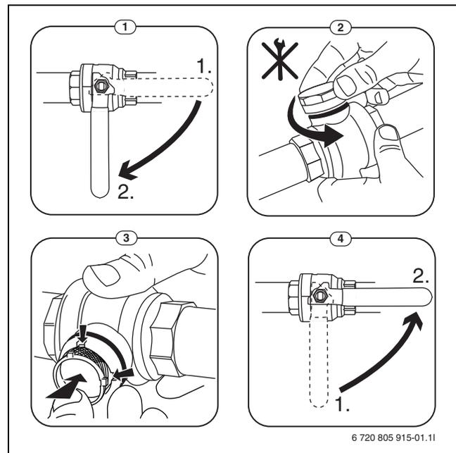
Bild 18 Siebreinigung
