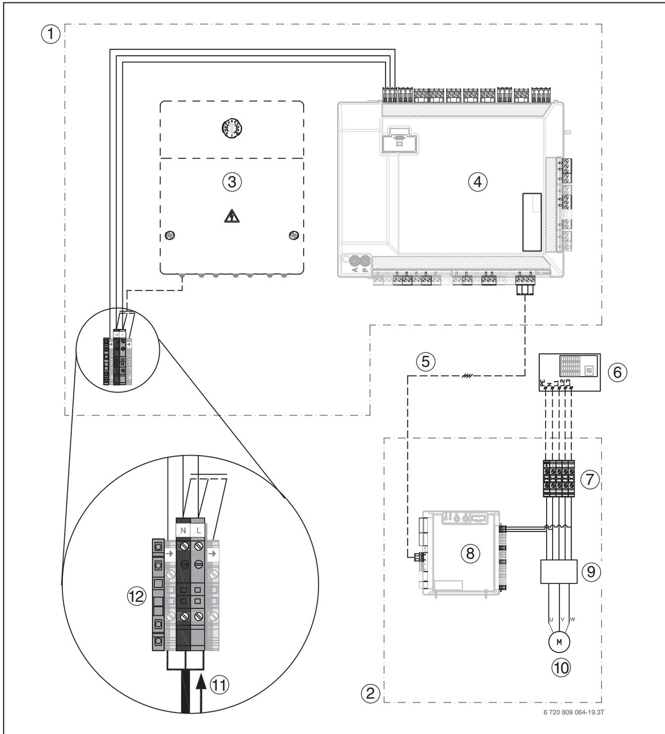
Bild 32 Dreiphasige Wärmepumpe und Inneneinheit mit externem Zuheizter
