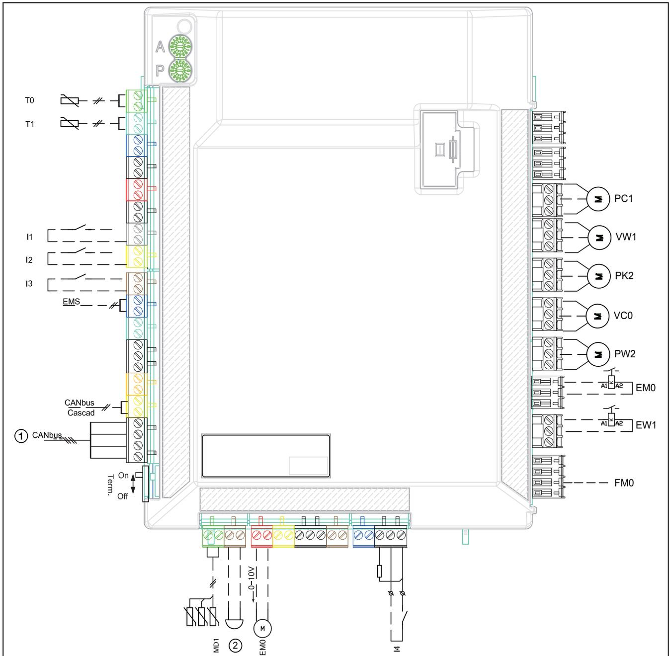
Bild 13 Anschlüsse Installationsmodul
