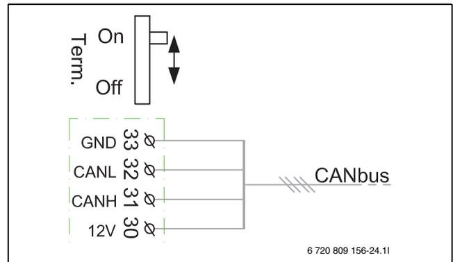
Bild 10 CAN-BUS-Terminierung
