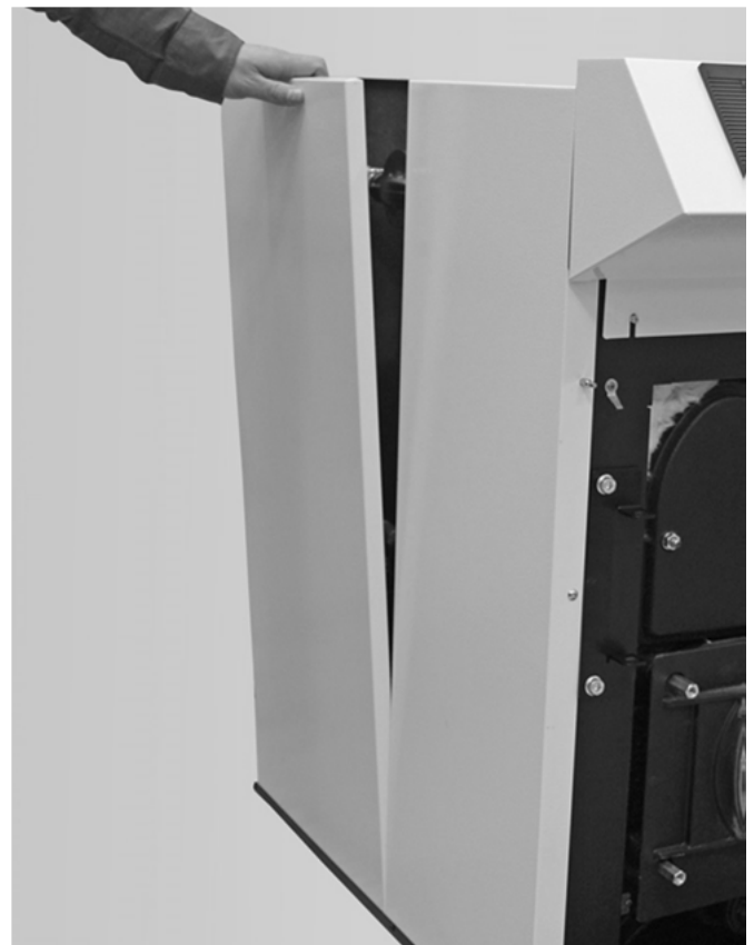
Abb. 60: Demontage der seitlichen Verkleidung
