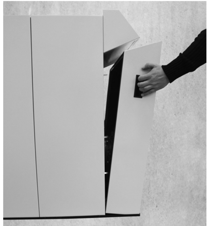
Abb. 59: Demontage der Kesselhaube
