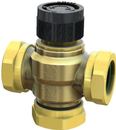
Das Tri CTB ist ein Dreiwegeventil, welches als Verteil- oder Mischventil verwendbar ist. Für den Einsatz als Verteilventil hat das Tri CTB einen Eingang (AB) und zwei Ausgänge (A und B). Das durchfließende Medium wird je nach Stellung der Spindel von einem auf den anderen Ausgang umgelenkt.
