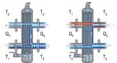
In diesem Fall übersteigt die Nachfrage das Angebot. Ein Teil des kälteren Rückwassers gelangt mit in die Zufuhr, so dass es länger dauert, bis die Räume temperiert sind. Wenn möglich, ist in der Folge die Leistung des Kessels oder Kühlers anzuheben.
