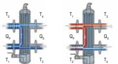
Im dritten Fall übersteigt das Angebot die Nachfrage. Ein Teil des wärmeren Zulaufwassers gelangt nun in das Rücklaufwasser, was ein Absinken des Wirkungsgrads von Kessel oder Kühler zur Folge hat. Wenn möglich, ist die Leistung zurück zu modellieren.
