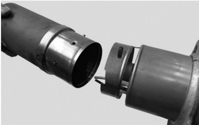
Abb. 3: Montage Keramikrohr auf Stützrohr
