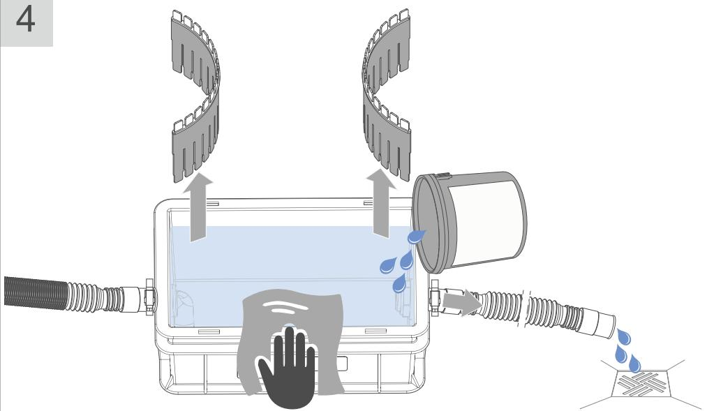
Frisches Neutralisationsgranulat einfüllen | Fill in new neutralisation granulate
