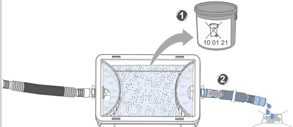
Neutralisationsgranulat entnehmen | Remove neutralisation granulate
