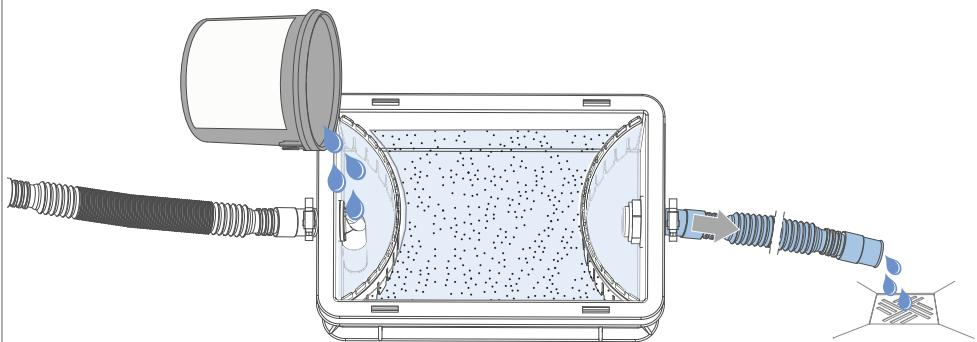
Behälter schließen, Dichtheit prüfen | Close the box, check for leaks
