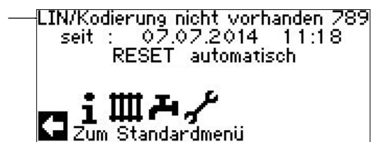
Beispiel eines im Bildschirm angezeigten Verbindungsfehler
