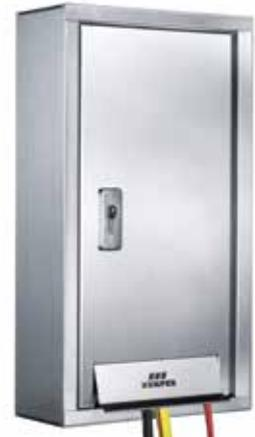
KEMPER TRESOR Wandaufputzschrack Figur 213, H/B/T: 510x285x130 mm, für die nachträgliche schnelle und saubere Installation bei bereits fertiggestellter Außenwand und bei nicht ausreichender Wandstärke für den Einbau Unterputz. Speziell für chlorhaltige Umgebungen (z. B. Schwimmbäder) ist der KEMPER TRESOR Wandaufputzschrack Figur 214 erhältlich.
