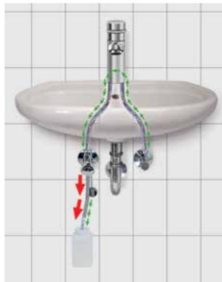
Probenahme am Eckventil PWH. Bei einem technischen Mangel in der Armatur kann es zum Überströmen von PWC in die Probe für PWH kommen.
