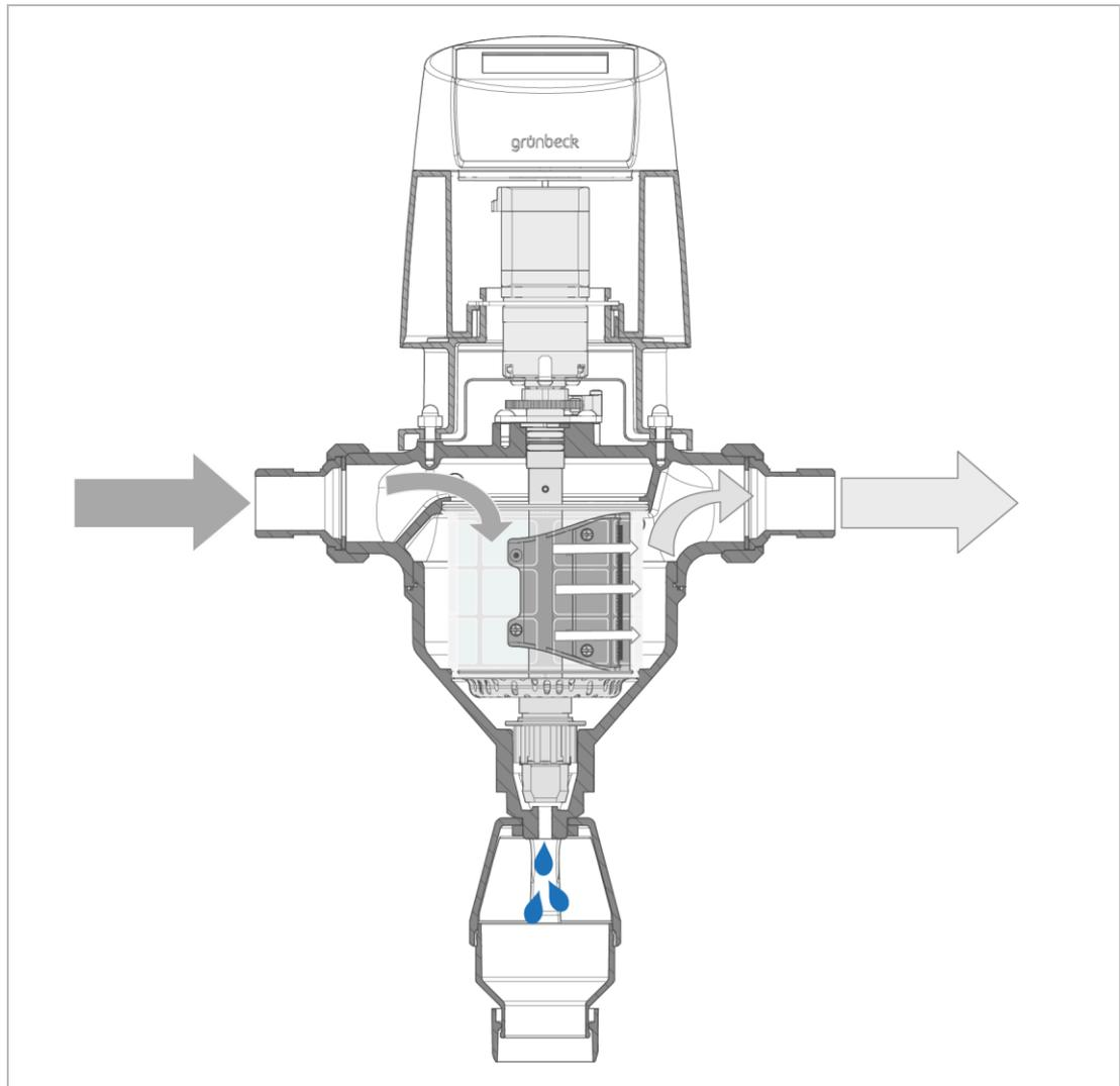
Das ungefilterte Rohwasser strömt durch die Eingangsseite in den Filter und dringt von innen nach außen durch das Filterelement zum Reinwasserausgang. Dabei werden Fremdpartikel mit einer Größe von  $> 100 \mu\text{m}$  zurückgehalten.
