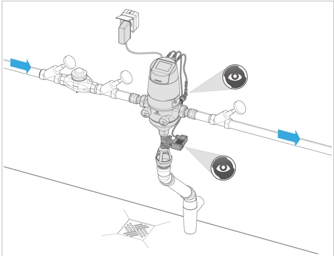
6. Sichten Sie das Sicherheitsmagnetventil (optional) und die Drucksensoren (optional) auf Beschädigungen.
