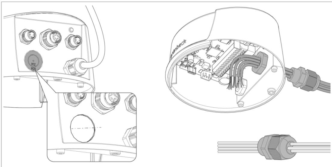
5. Stellen Sie eine passende Bohrung für die Kabelverschraubung her.
