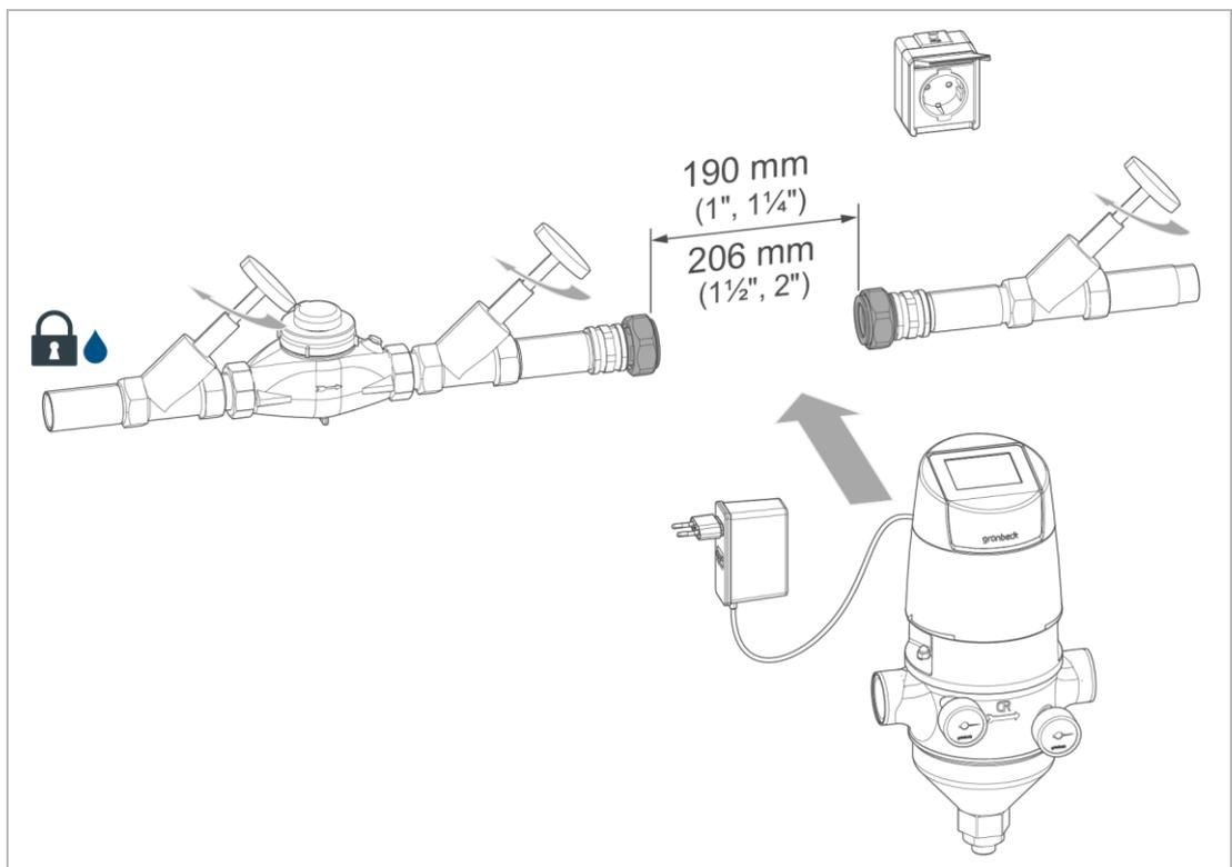
1. Installieren Sie die Wasserzählerverschraubung in die Rohrleitung.
