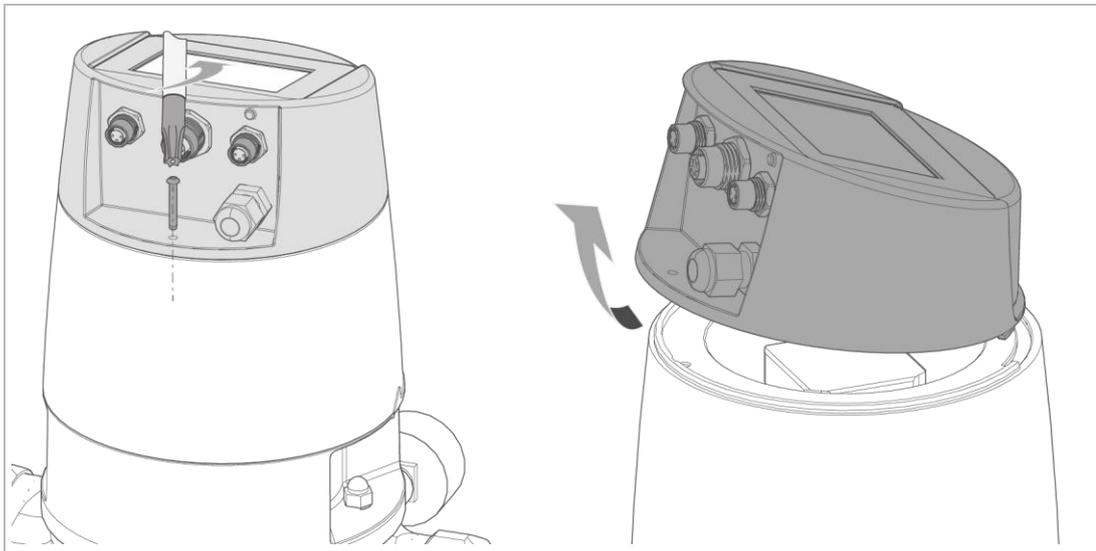
4. Lösen Sie die hintere Schraube der Steuerungshaube.
