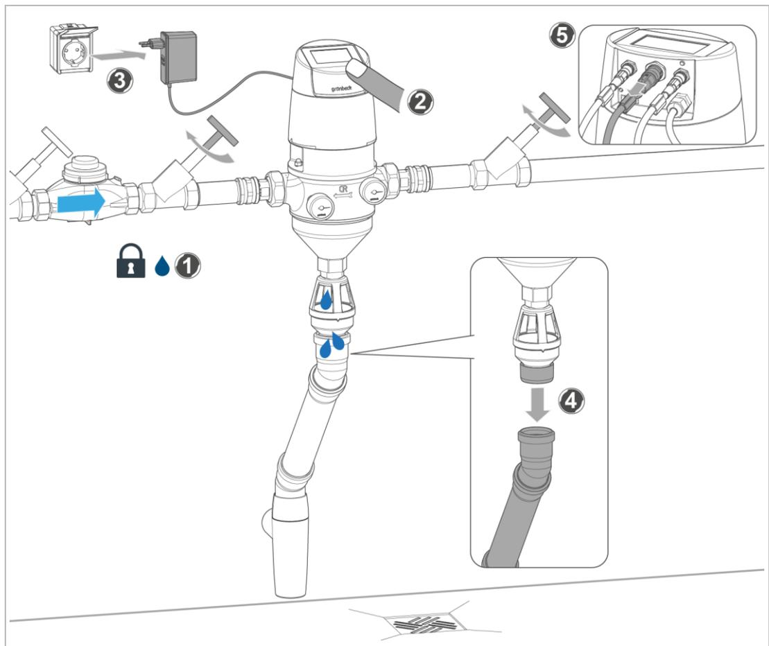
1. Schließen Sie die Absperrventile am Eingang und Ausgang.
