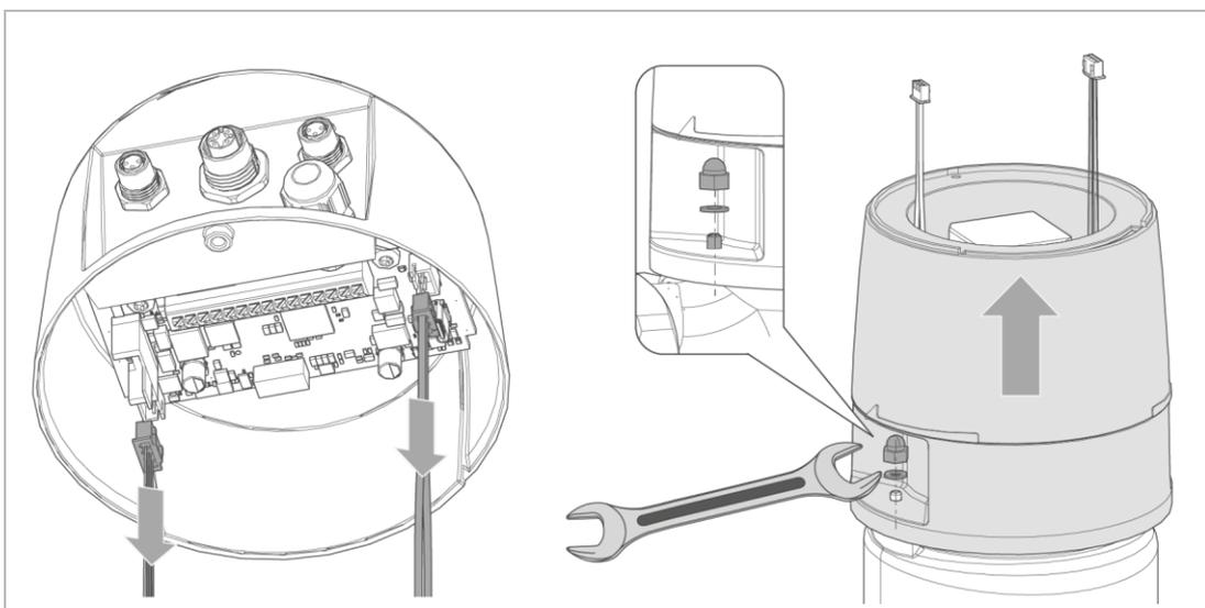
6. Lösen Sie die Steckverbindungen der Positionssensorik und der Antriebseinheit von der Platine.
