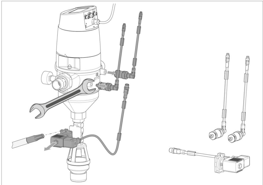
1. Lösen Sie die Steckverbindungen am Filterkopf.
