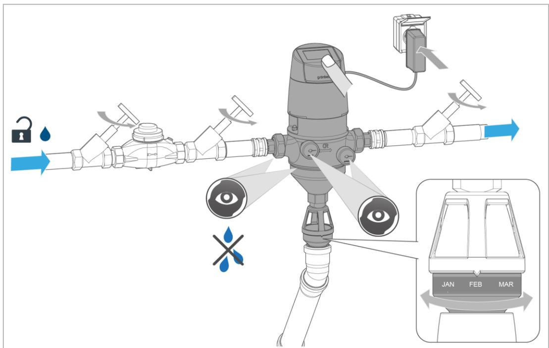
1. Prüfen Sie den Festsitz des Filters in der Rohrleitung.
