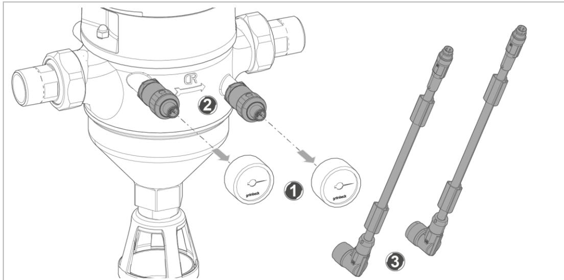
1. Demontieren Sie die Manometer.
