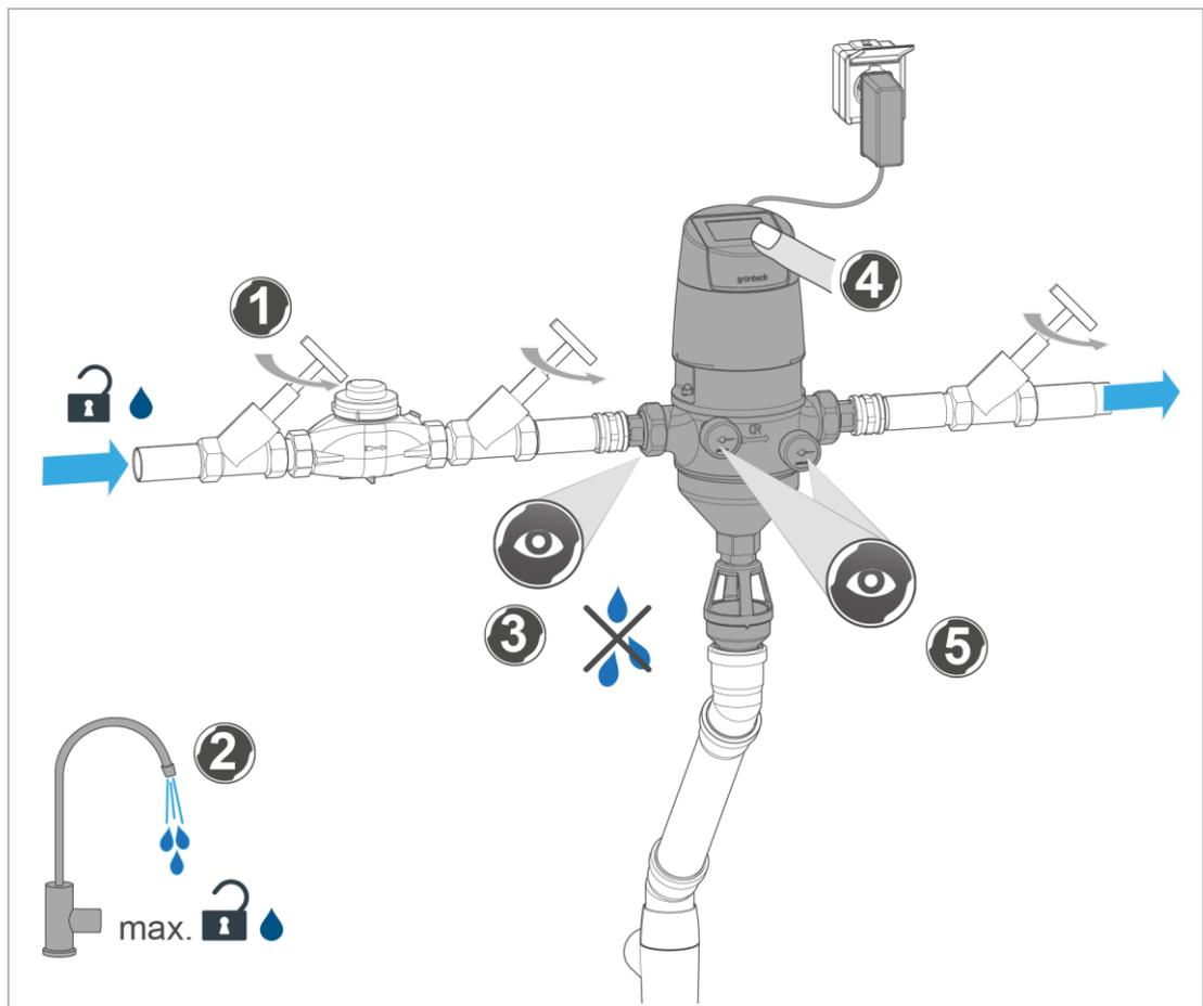
1. Öffnen Sie die Absperrventile.
