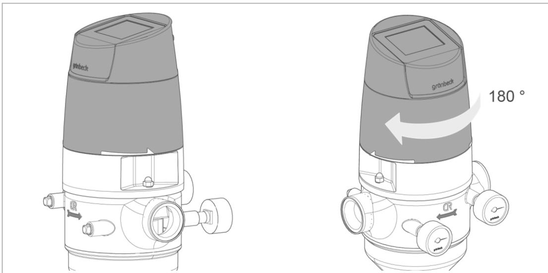
4. Drehen Sie den Steuerkopf um 180° bis zum Anschlag.
