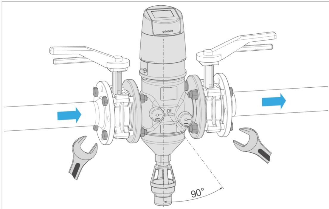
2. Positionieren Sie den Filter in die Rohrleitung.
