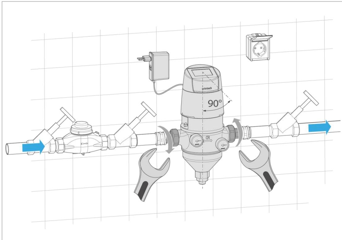
3. Installieren Sie den Filter spannungsfrei und ziehen Sie die Überwurfmutter fest an.
