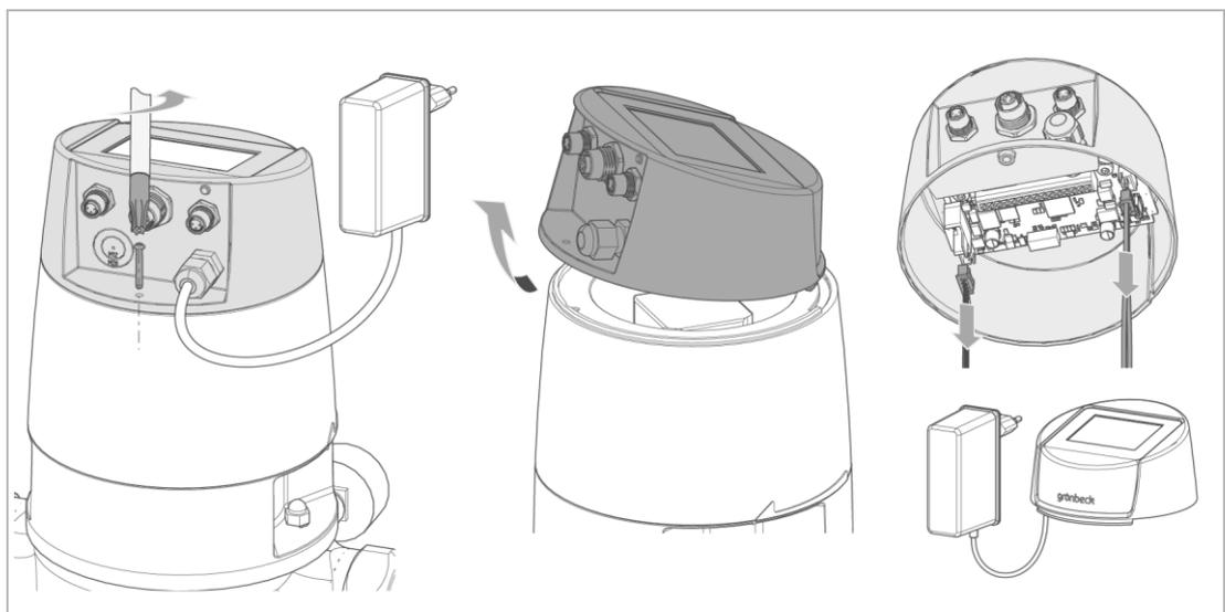
6. Lösen Sie die hintere Schraube der Steuerungshaube.
