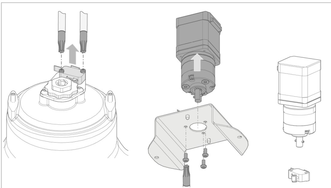
13. Lösen Sie die 2 Schrauben des Mikroschalters und entnehmen Sie diesen.
