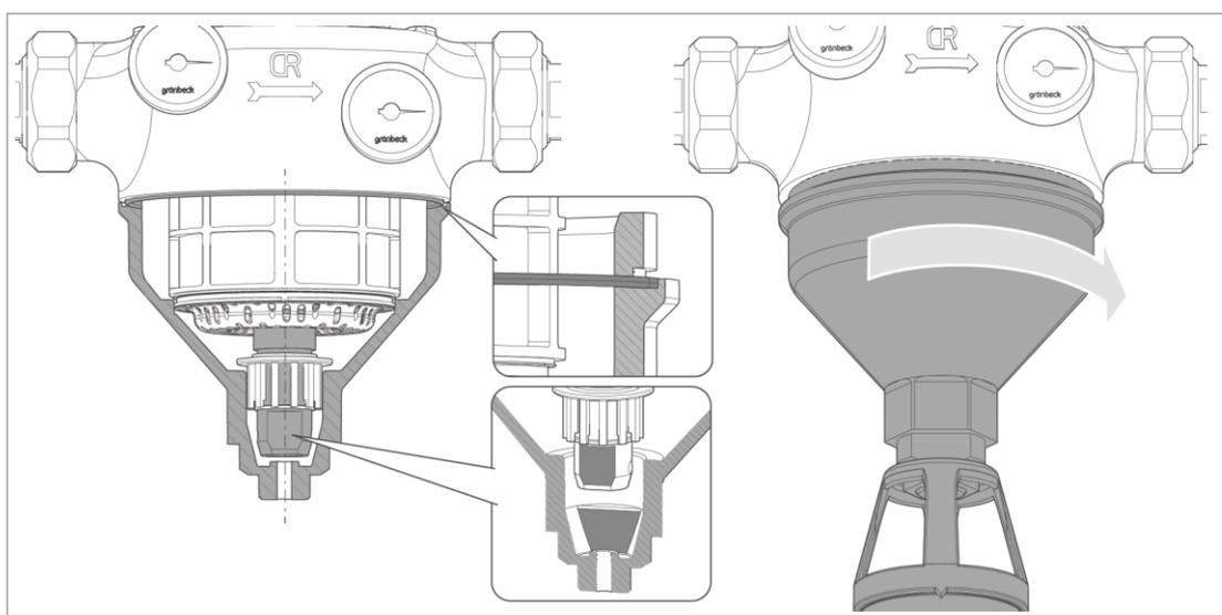
5. Schrauben Sie den Filtertrichter auf das Filtergehäuse.
