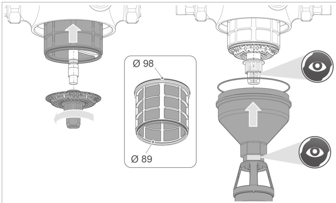
1. Ziehen Sie die O-Ringe auf die Filterelemente. Schieben Sie die Filterelemente mit dem größeren Ø voran über die Absaugdüse in das Filtergehäuse.
