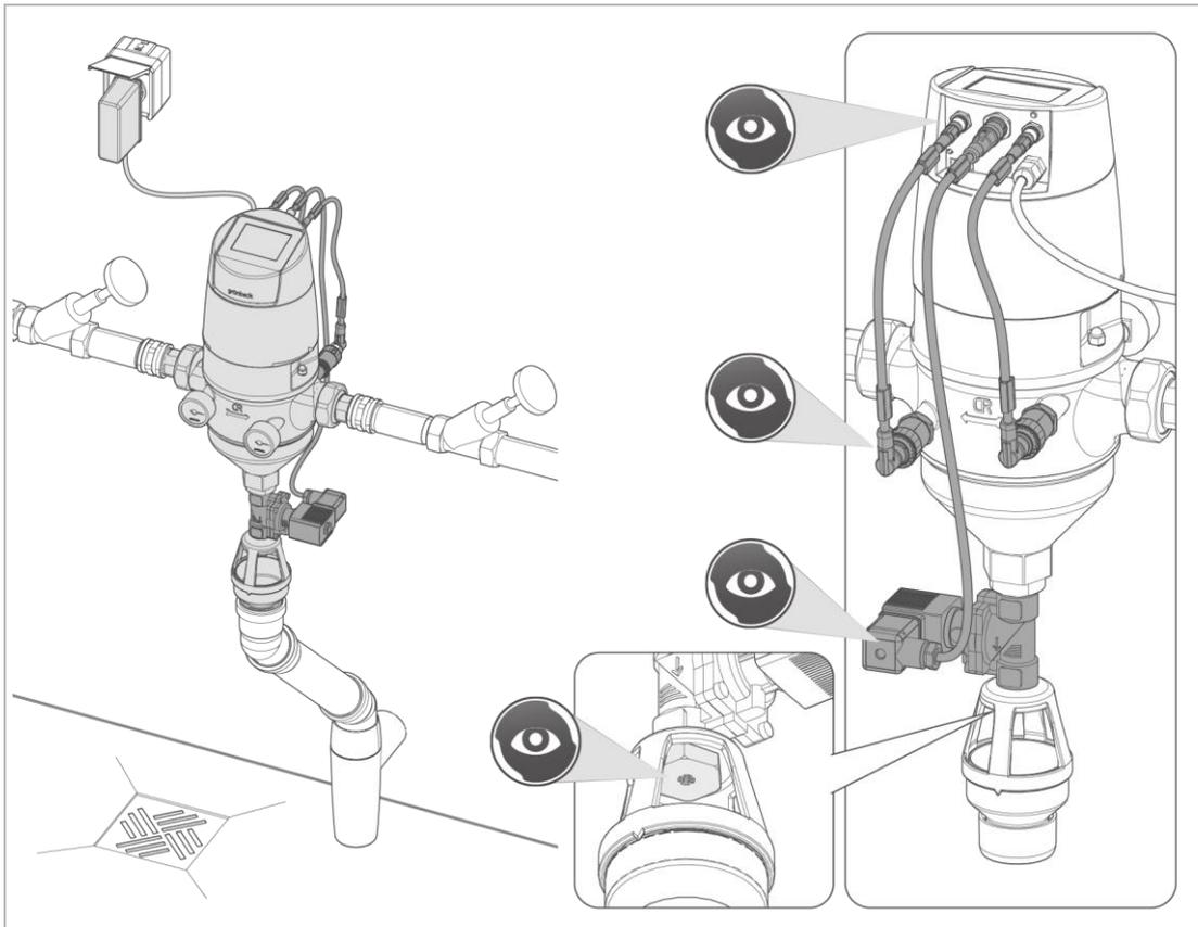
3. Prüfen Sie das optionale Sicherheitsmagnetventil auf Dichtheit und Unversehrtheit.
