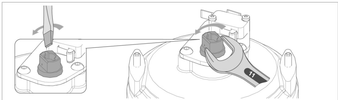
13. Drehen Sie die Rohrdüse mit einem Maulschlüssel oder Schraubendreher bis zum mechanischen Anschlag nach links.
