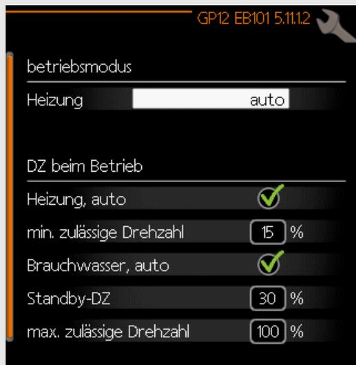
In diesem Menü stellen Sie ein, mit welcher Drehzahl die GP10 Umwälzpumpe im aktuellen Betriebsmodus arbeiten soll. Wählen Sie „Auto“ aus, wenn die Ladepumpendrehzahl für einen optimalen Betrieb automatisch geregelt werden soll.
