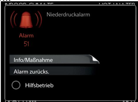
Ein roter Alarm zeigt an, dass ein Fehler aufgetreten ist, der nicht allein von der Wärmepumpe und/oder dem Steuergerät behoben werden kann. Durch den Drehknopf und Drücken der OK-Taste können Sie die Alarmart anzeigen und den Alarm löschen. Die Installation kann auch in den Hilfemodus versetzt werden.
