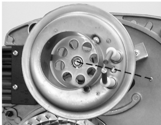
Abb. 25: Mischsystempositionierung und Ausrichtung Zündelektrode
