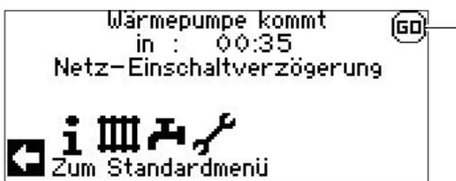
Durch Ansteuern und Anklicken von „GO“ wird der Inbetriebnahme-Assistent aufgerufen. Dieser führt Sie bei der Erstinbetriebnahme durch die wichtigsten Einstellungen der Regelung.
