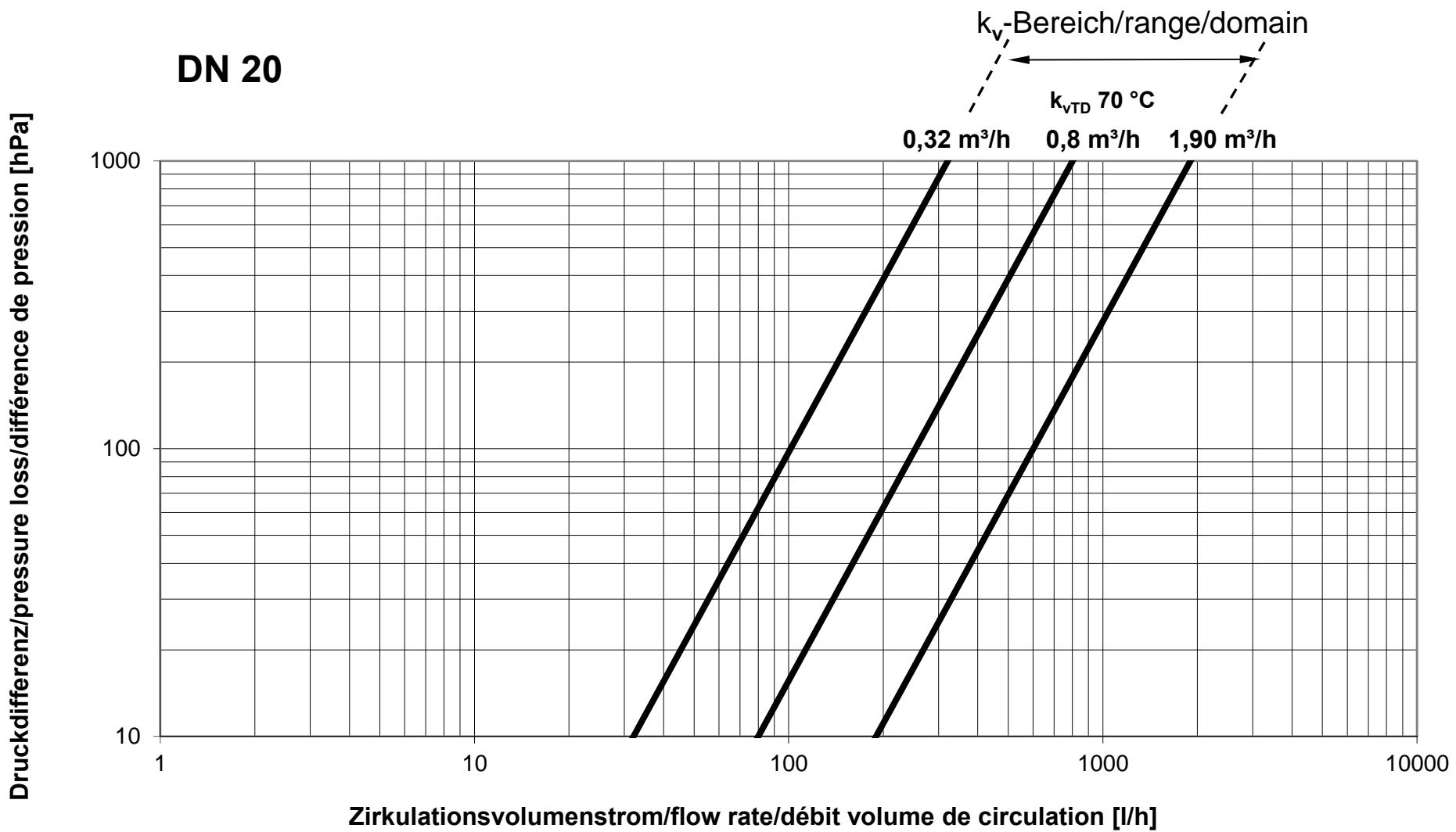
Durchflussdiagramm/Flow Diagram/Diagramme de débit
