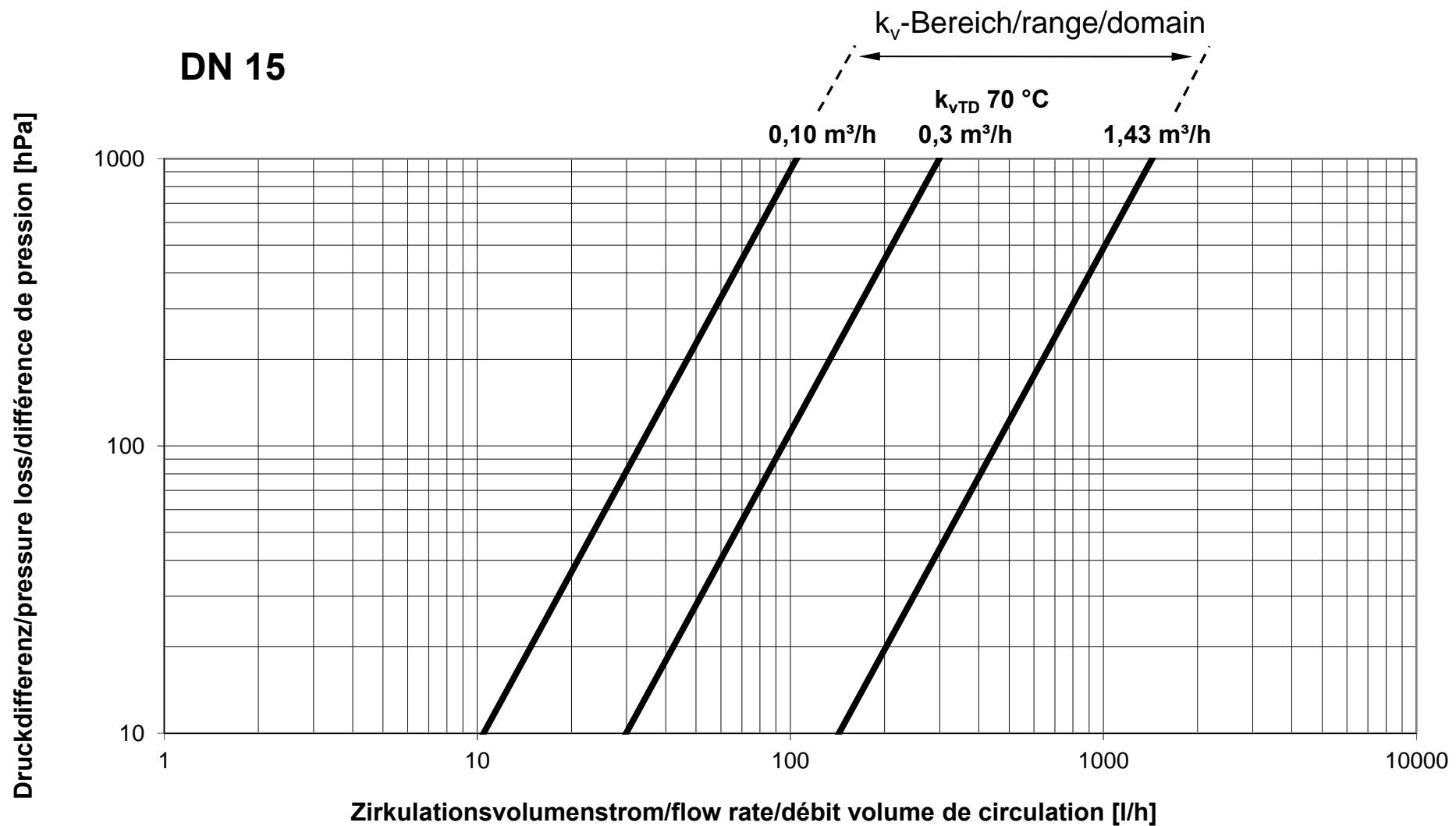
Durchflussdiagramm/Flow Diagram/Diagramme de débit
