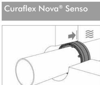
... bis der Dichtungseinsatz etwa bündig mit der Außenwand (Wasser-/Druckseite) abschließt.
