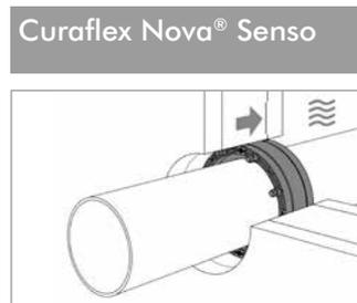
Dichtungseinsatz in der Dichtebene der Wand positionieren. Sollten Unklarheiten hinsichtlich der Lage der Dichtebene vorliegen, ist die Vorgehensweise mit dem Planer bzw. dem Wandhersteller abzustimmen.
