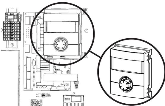
2. Das eingehängte Bedienteil nach unten drücken, bis es einrastet.
