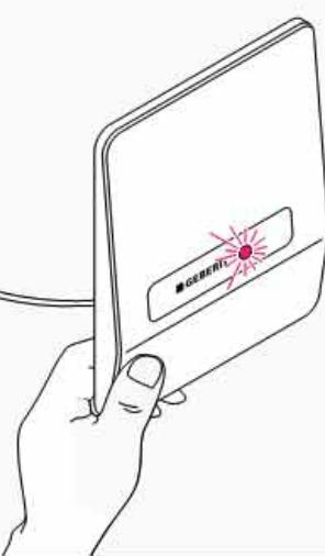
Die Kontrolleuchte zeigt durch Blinken die neu eingestellte Spülzeit an. (1 x Blinken = 1 sec.)
