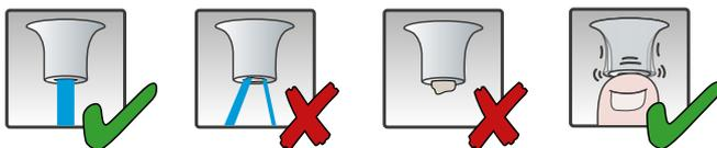
**Aufputz Tellerkopfbrausen sowie Deckeneinbaubrausen sind regelmäßig auf Kalkrückstände zu prüfen.** Die Hauptablagerung von Kalk befindet sich an den Silikon-Wasserauslässen (Antikalkknoppen). Hier ist darauf zu achten, dass diese je nach Härte des Wassers einen Kalkkorken bilden, welche die Strahlen zunächst in der Richtung verstellen und später komplett verschließen. Hier muss regelmäßig manuell über die Antikalkknoppen gestrichen werden, um die Knoppen vom Kalk zu befreien.
