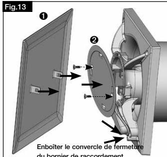
1. Emboîter le couvercle du bornier de raccordement ② dans la rainure, appuyer sur le caisson et serrer fermement les vis.
