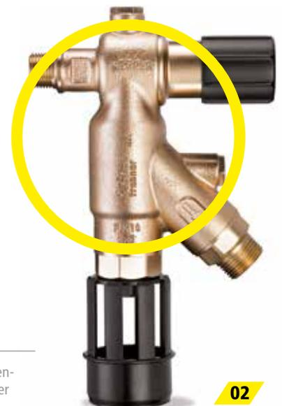
KEMPER FK-4: Die untrennbare Einheit von Systemtrenner und Auslaufventil macht einen Direktanschluss der Heizungsanlage an das Auslaufventil unmöglich.
