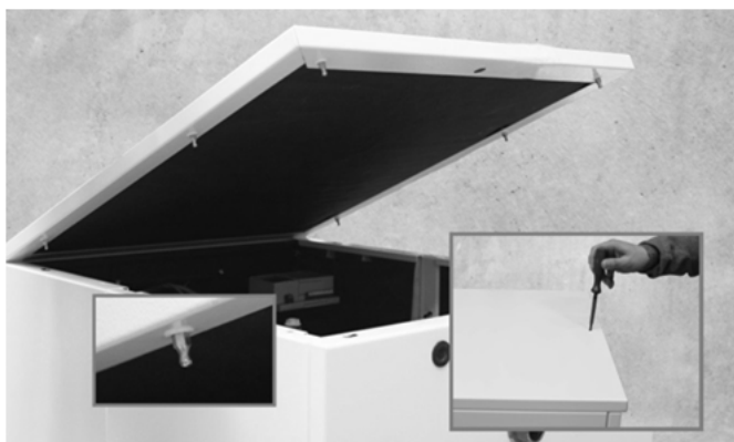
Abb. 57: Demontage der oberen Verkleidung
