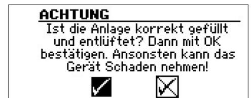
Die Sicherheitsabfrage erscheint immer beim Einschalten der Reglerspannung oder nach einem Neustart des Heizungs- und Wärmepumpenreglers (Reset).
