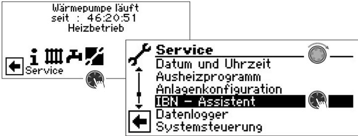
Schrittweise werden Sie durch mehrere Auswahlmöglichkeiten geführt, mit denen Ihre Wärmepumpe eingestellt wird.
