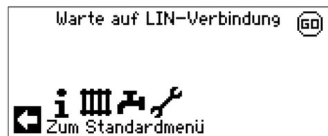
angezeigt werden sollte, den Heizungs- und Wärmepumpenregler vom Stromnetz nehmen, die 3-polige Leitung für die BUS-Verbindung prüfen und gegebenenfalls Mangel beheben.
