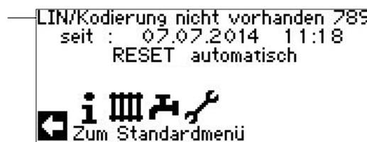
Beispiel eines im Bildschirm angezeigten Verbindungsfehlers
