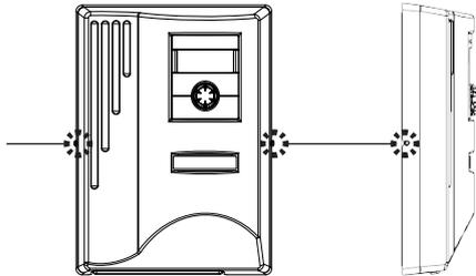
5. Gehäuseabdeckung abheben und an sicherer Stelle ablegen.
