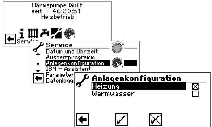
Nicht benötigten Programmbereich abwählen. Das Abbildungsbeispiel besagt, dass die Menüs des Programmbereichs „Heizung“ im Bildschirm angezeigt werden. Die Menüs des Programmbereichs „Trinkwarmwasser“ werden nicht angezeigt.
