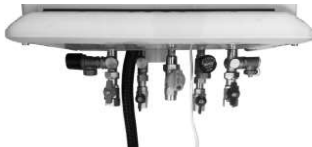
Abb. 12: Hydraulische Trinkwasseranschlüsse inkl. einem zusätzlichen Sicherheitsventil von max. 8 bar
