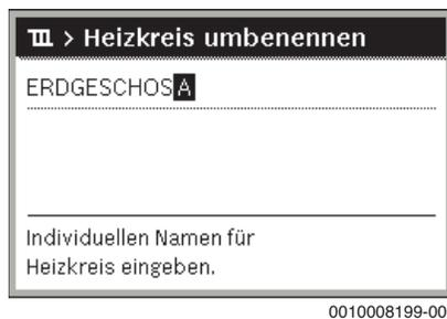
Das ausgewählte Zeichen wird eingegeben (eingefügt). Das Eingabefeld für die nächste Stelle im Text wird aktiviert.
