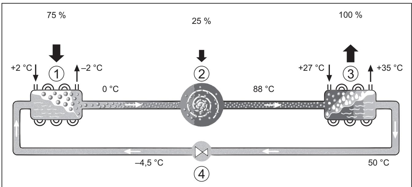
Bild 1 Funktionsprinzip des Kältemittelkreises in der Wärmepumpe
