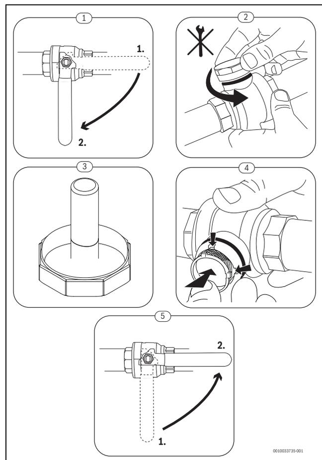
Bild 5 Siebreinigung
