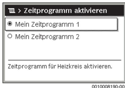
Die Bedieneinheit arbeitet im Automatikbetrieb mit dem ausgewählten Zeitprogramm. Wenn 2 oder mehr Heizkreise installiert sind, gilt diese Einstellung nur für den ausgewählten Heizkreis.
