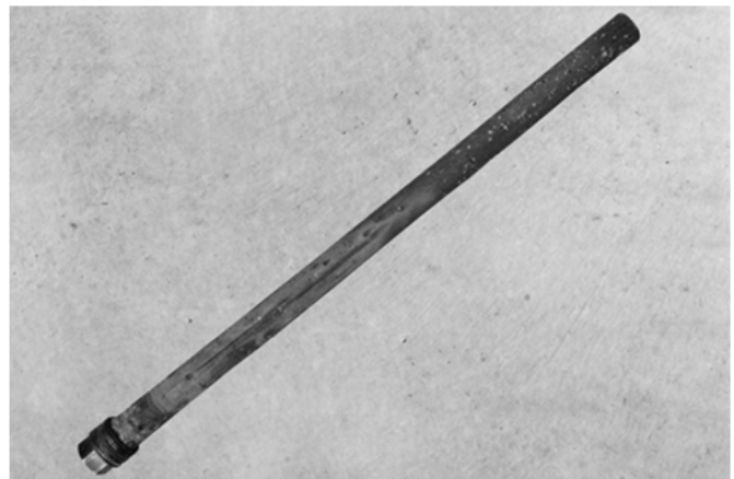
Abb. 87: Magnesium-Schutzanode, Länge 480 mm, Ø 26 mm
