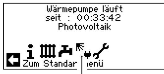
Sobald Eigenstrom zur Trinkwarmwasser- beziehungsweise Heizwasserbereitung genutzt wird, wird dies im Navigationsbildschirm angezeigt:
