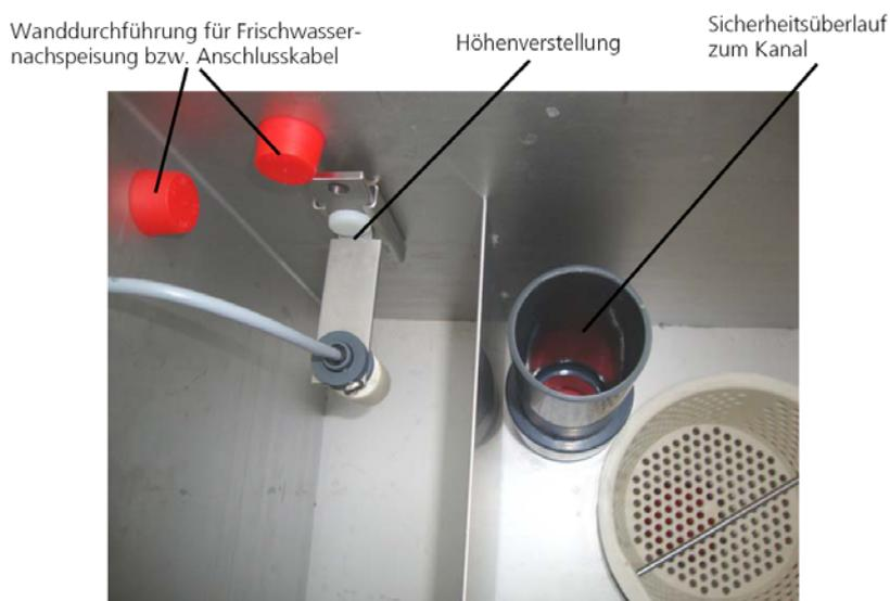
Abb. 4: Oberflächenabsauger Basis 200
