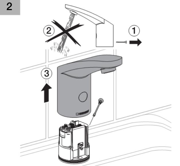
**3** Die Schritte a-c müssen viermal in Folge durchgeführt werden. (a) Armaturenkörper auf die Kontakte drücken, bis (b) LED für eine 1 s aufleuchtet, dann (c) Armaturenkörper sofort wieder um 3 cm hochschieben.
