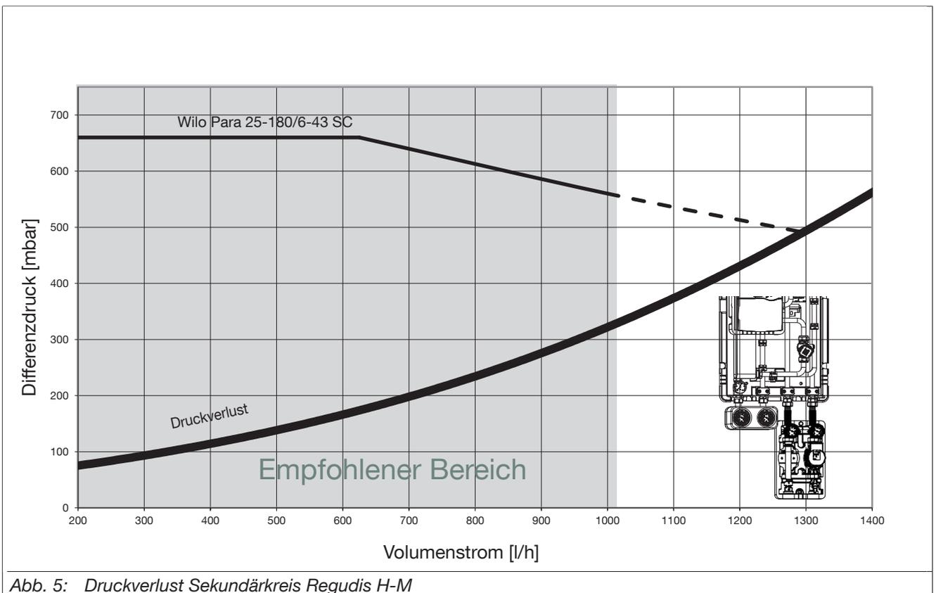
Abb. 5: Druckverlust Sekundärkreis Regudis H-M
