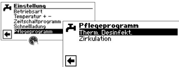
Die thermische Desinfektion ermöglicht, die Trinkwassertemperatur mit einem zusätzlichen Wärmeerzeuger (ZWE) auf eine höhere Temperatur zu bringen als jene, die mit der Wärmepumpe erreichbar ist. Die thermische Desinfektion wird ausschliesslich über zusätzliche Wärmeerzeuger bereitet; der Verdichter der Wärmepumpe bleibt ausgeschaltet.
