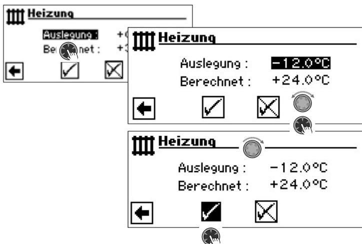
Das Programm des Heizungs- und Wärmepumpenreglers berechnet nun die bei -12 °C tatsächliche Rücklauf­temperatur für den Heizkurven-Endpunkt und zeigt sie im Menüfeld „Berechnet“ an. Im Beispiel +24,0 °C:
