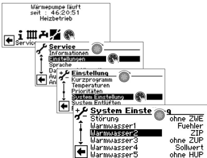
Falls das Menüfeld „Warmwasser2“ unter „System Einstellung“ nicht sichtbar ist, müssen Sie diese Einstellung über das Menü „FlexConfig“ vornehmen (OUT 2 = ZIP)::
