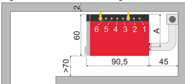
Abgasrohr-Anschluss nach oben gerichtet
