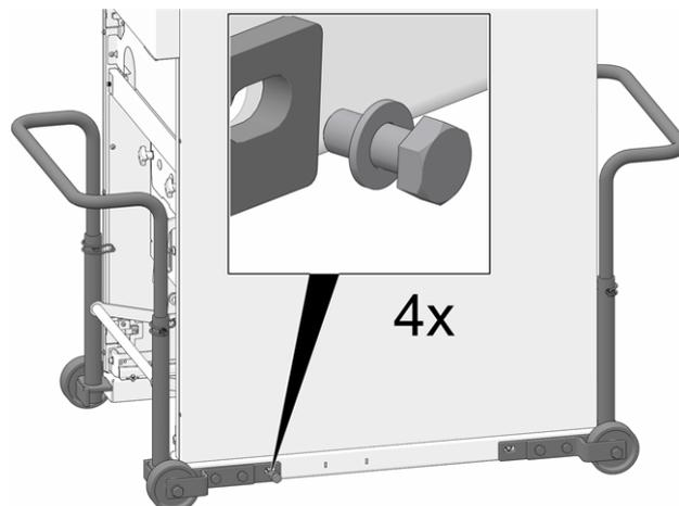
Abb. 2-1: Tragehilfe montiert
