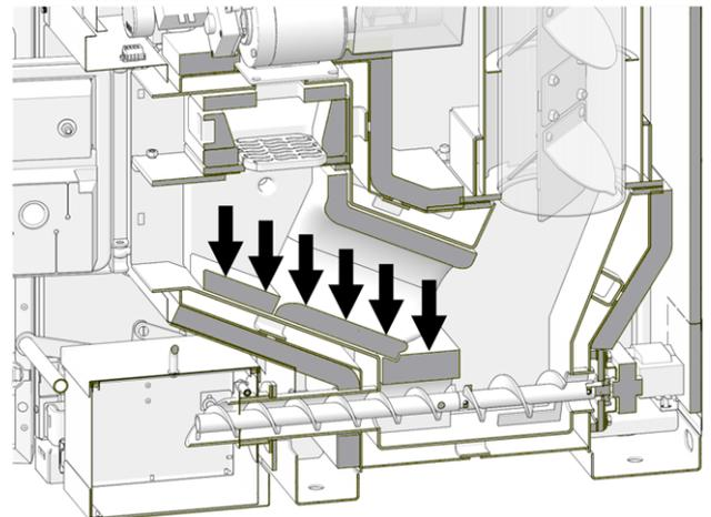
Abb. 2-58: Im Brennraum abgelagerte Asche entfernen
