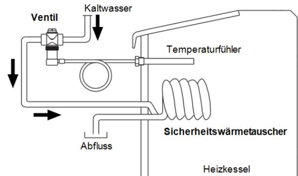
Abb. 2-5: Schematische Darstellung
