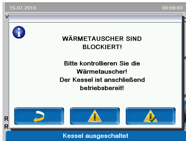
Abb. 28 Warnung Wärmetauscher blockiert
