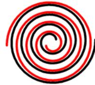
Der Verdichter verdichtet das Kältemittel von niedrigem Druck auf hohen Druck. Durch die Verdichtung steigt auch die Temperatur des Kältemittels. Der Verdichter pumpt somit die Wärme von einem niedrigen Temperaturniveau auf ein hohes Niveau.
