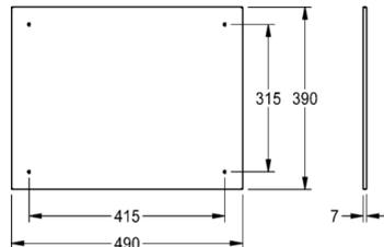
Spiegel, Chromnickelstahl, hochglanzpoliert, Materialstärke 1,0 mm, umlaufende Abkantung, diebstahlhemmendes Vorwandmontagesystem durch untergelegte Polystyrolplatte mit verdeckter Befestigung (Klebeband), inklusive Edelstahlschrauben und Dübel.
