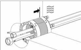
Dichtungseinsatz in Kernbohrung/Futterrohr schieben bis dieser etwa bündig mit der Außenwand (Wasser-/Druckseite) abschließt.
