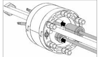
Zwiebelschnitteinsätze in den Dichtungseinsatz schieben.
