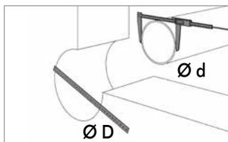
Durchmesser von Kernbohrung bzw. Futterrohr und der Medienleitung bestimmen und mit den Angaben auf dem Karton abgleichen.
