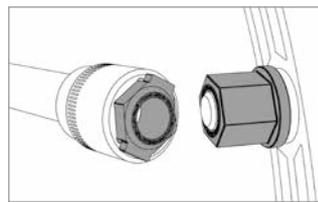
Solange fortfahren bis sich die oberen Muttern abdrehen (ITL-Prinzip: Integrated Torque Limiter; kein Spezial-Werkzeug nötig.)
