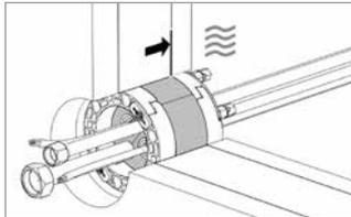
Dichtungseinsatz in der Dichtebene der Wand positionieren. Sollten Unklarheiten hinsichtlich der Lage der Dichtebene vorliegen, ist die Vorgehensweise mit dem Planer bzw. dem Wandhersteller abzustimmen.
