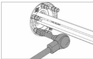
Zur Endmontage des Dichtungseinsatzes die Muttern (SW 10) anziehen.
