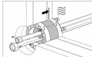
Dichtungseinsatz in der Dichtebene der Wand positionieren. Sollten Unklarheiten hinsichtlich der Lage der Dichtebene vorliegen, ist die Vorgehensweise mit dem Planer bzw. dem Wandhersteller abzustimmen.
