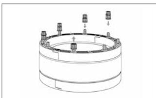
Bereits getrennte Muttern wechselweise über Kreuz in mehreren Intervallen entfernen. Neue Muttern verwenden (optional lieferbar) und Montage wie unter 4 fortsetzen, oder ...
