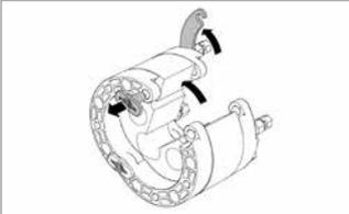
Schnellverschluss und gegenüberliegenden Stift herausziehen, Dichtungseinsatz auseinanderklappen und um die Leitungen legen. Schnellverschluss verschließen. Stift wieder einsetzen.
