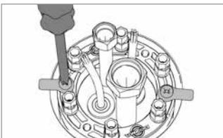
Bei der Montage in einem Quadro-Sicura® ADS Rohbauteil sind vor dem Einsetzen die Fixierlaschen mittels handelsüblichen Schraubendreher auf den Gestellring aufzuschrauben.
