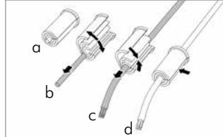
Aus den Zwiebelring (a) den Stopfen (b) entfernen und den Zwiebelschnitteinsatz um das Kabel/Rohr klappen (c). Dabei so viele Lagen durch Herausreißen entfernen bis sich die Teilungsschnittflächen des Zwiebelschnitteinsatzes beim Umschließen des Kabels/Rohres berühren aber nicht überlappen (d).
