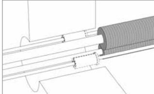
Bei gedämmten Leitungen ist vor der Montage die Dämmung im Bereich des Dichtungseinsatzes zu entfernen.
