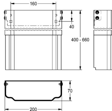
Gehäuseverlängerung aus Edelstahl, höhenverstellbar, für F5-Duschpaneele aus Edelstahl, zur Verkleidung von Aufputzrohrinstallationen, komplett mit Befestigungsmaterial.
