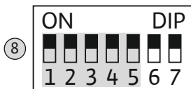
Fig. 9: DIP-Schalter 1: Motorstromüberwachung einstellen
