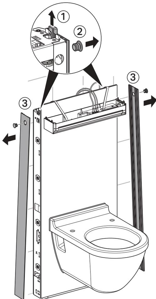
**i** Das Netzteil befindet sich je nach Einbausituation auf der linken oder der rechten Seite des Rahmens.
