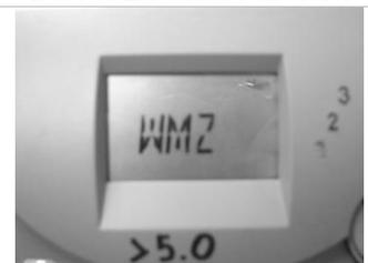
Pfeil rechts bis *WMZ* (Wärmemengenzähler)
