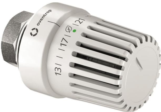
Oventrop Thermostate und Thermostatventile bilden gemeinsam einen ohne Hilfsenergie arbeitenden Proportionalregler. Sie regeln die Raumtemperatur durch Veränderung des Heizwasserdurchflusses.
