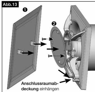
1. Anschlussraumabdeckung ② in Nut einhängen, auf Gehäuse drücken und Schrauben fest eindrehen.
