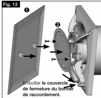
1. Emboîter le couvercle du boîtier de raccordement ② dans la rainure, appuyer sur le caisson et serrer.
