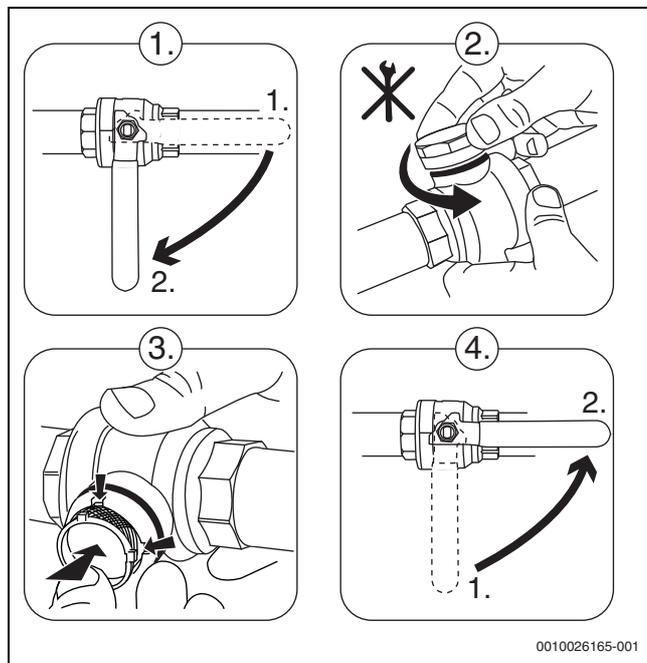
Bild 25 Aus- und Einbau des Partikelfilters (Beispiel)
