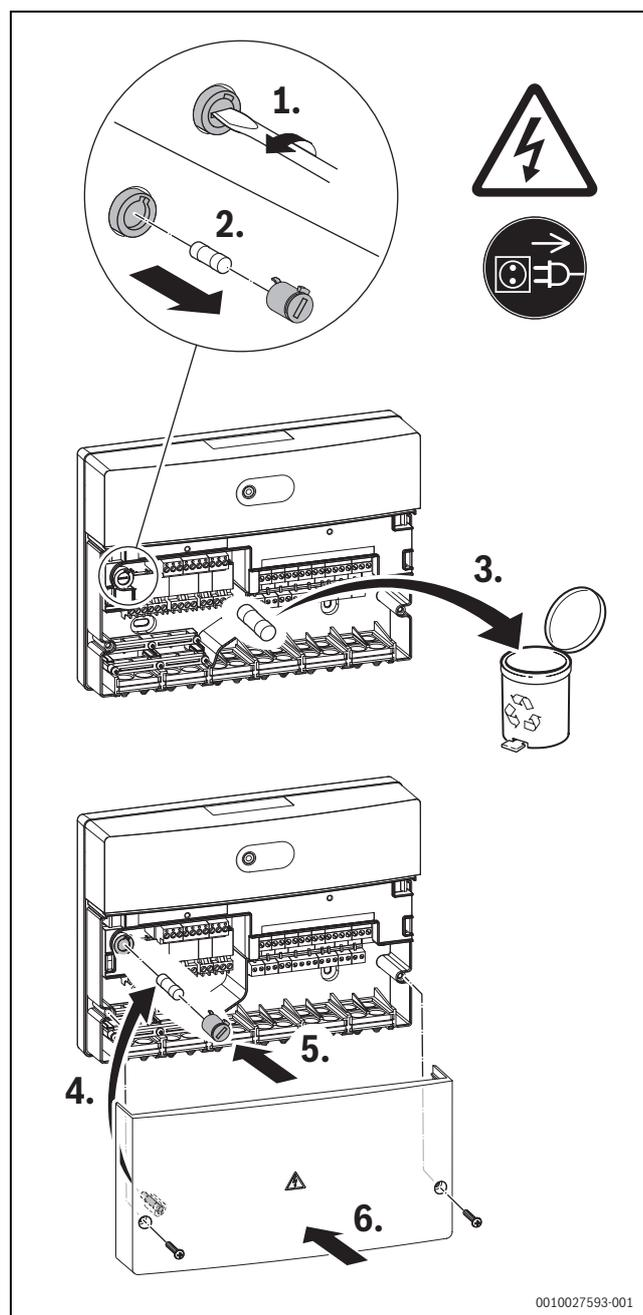
Bild 27 Sicherung tauschen
