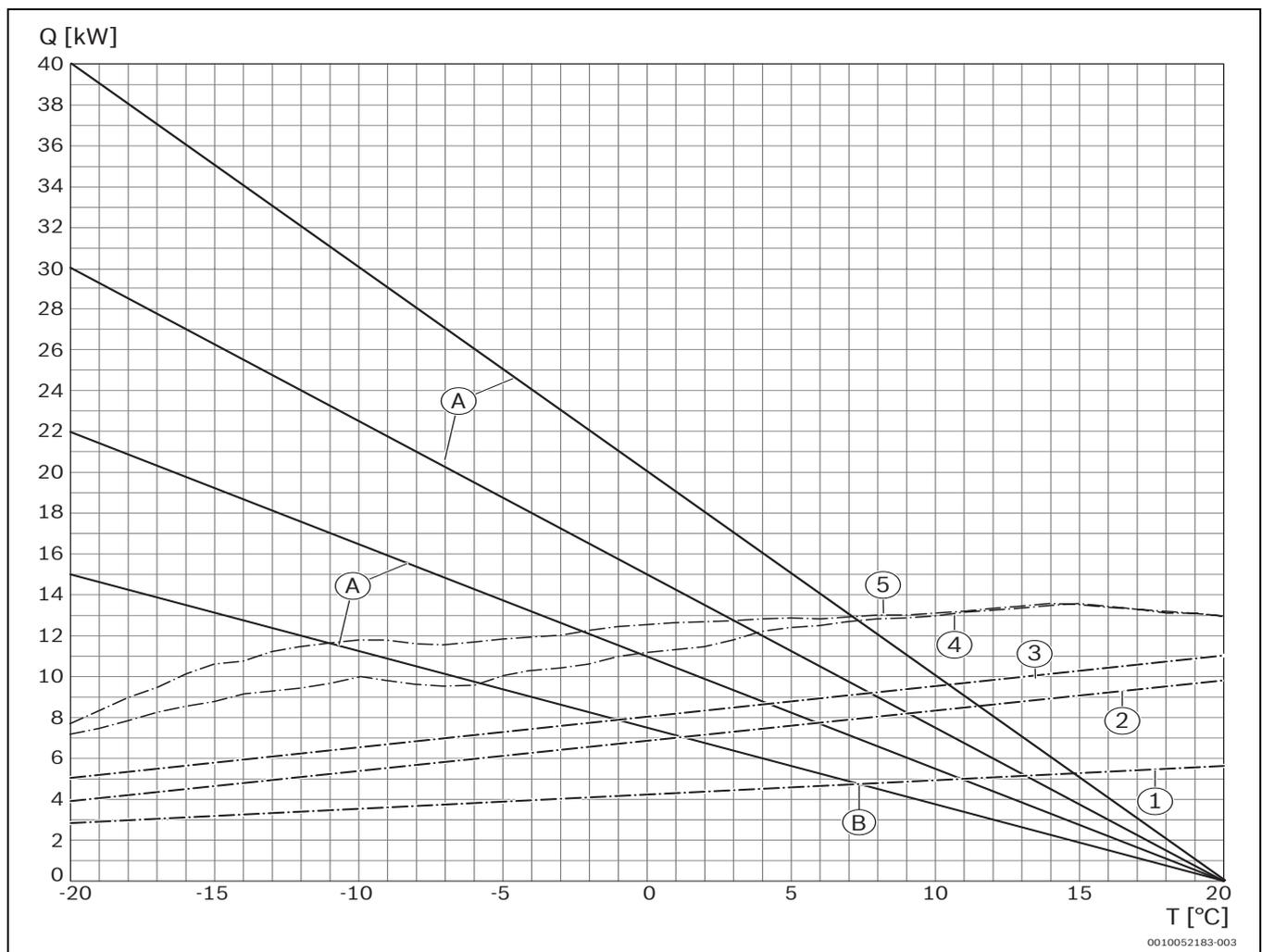
Bild 19 Diagramm zu Tab. 4; Zur Bestimmung der Bivalenzpunkte bei 35 °C Vorlauftemperatur
