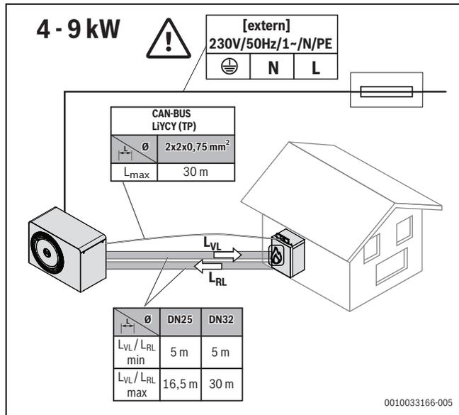
Bild 5 Anforderungen an Leitungslängen 4 – 9 kW
