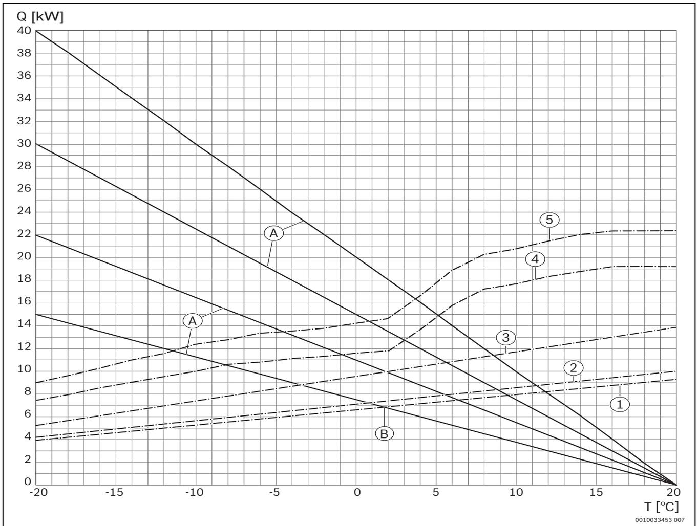
Bild 18 Diagramm zu Tab. 3; Zur Bestimmung der Bivalenzpunkte bei 35 °C Vorlauftemperatur
