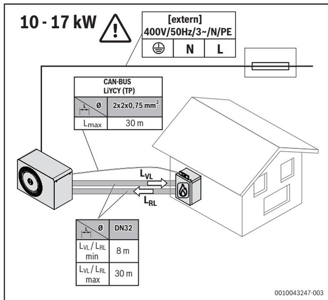
Bild 6 Anforderungen an Leitungslängen 10 – 17 kW
