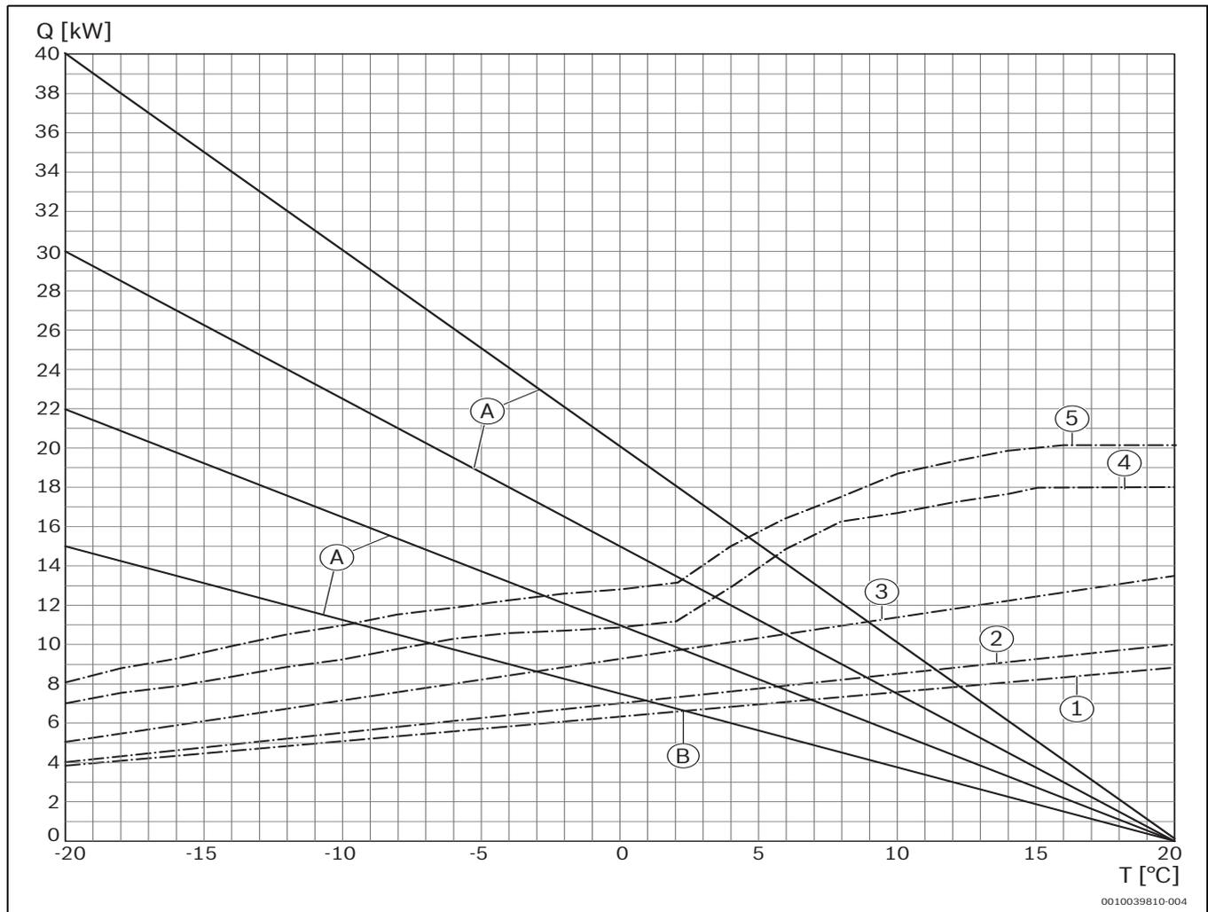
Bild 20 Diagramm zu Tab. 5; Zur Bestimmung der Bivalenzpunkte bei 45 °C Vorlauftemperatur
