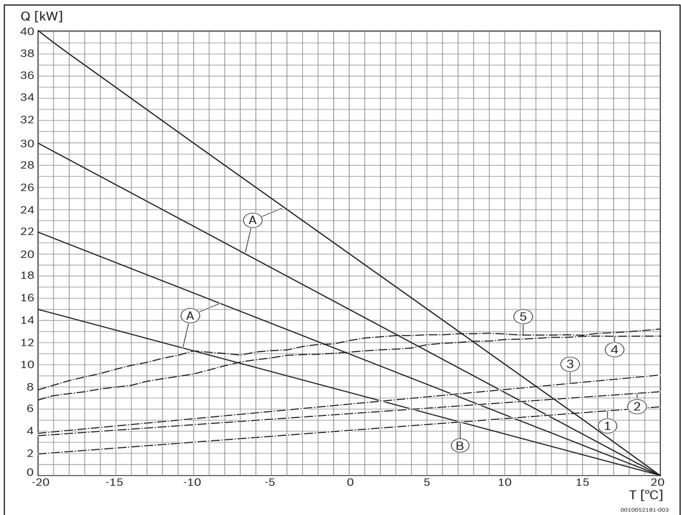
Bild 23 Diagramm zu Tab. 8; Zur Bestimmung der Bivalenzpunkte bei 55 °C Vorlauftemperatur
