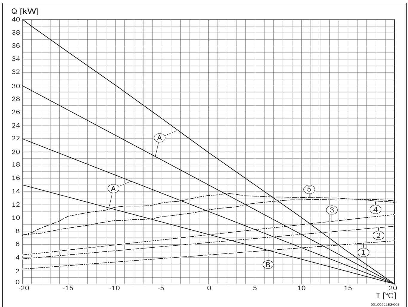
Bild 21 Diagramm zu Tab. 6; Zur Bestimmung der Bivalenzpunkte bei 45 °C Vorlauftemperatur
