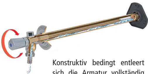
Konstruktiv bedingt entleert sich die Armatur vollständig und automatisch nach jedem Absperrvorgang. Ein Einfrieren der Armatur wird verhindert, Wasserschäden werden vermieden.
