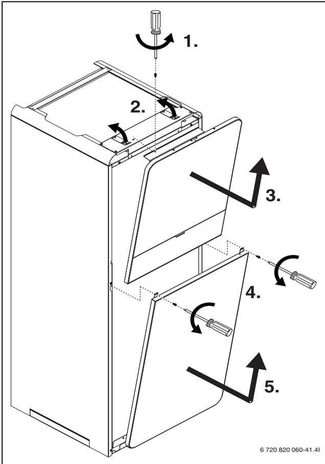
Bild 7 Frontplatten abnehmen
