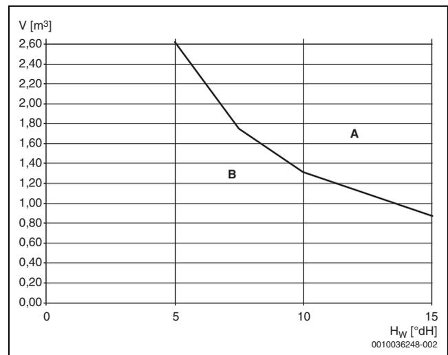
Bild 1 Grenzen für die Wasseraufbereitung bei Wärmepumpen-Anlagen
