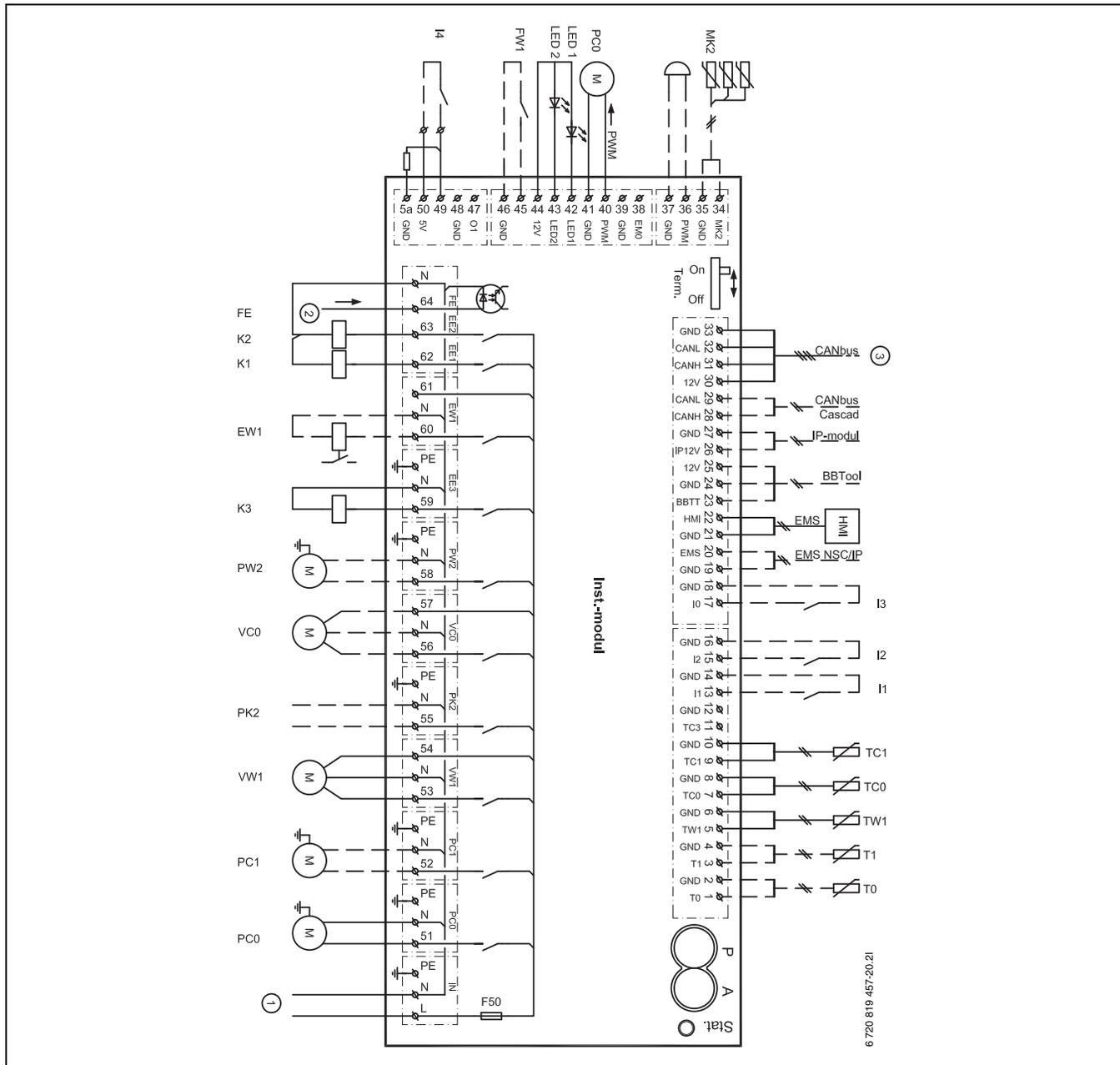
Bild 28 Schaltplan, Installationsmodul
