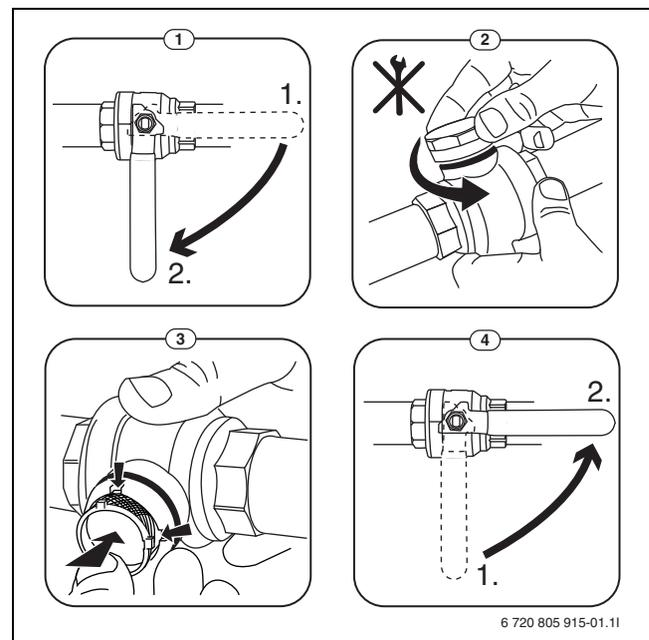
Bild 19 Siebreinigung
