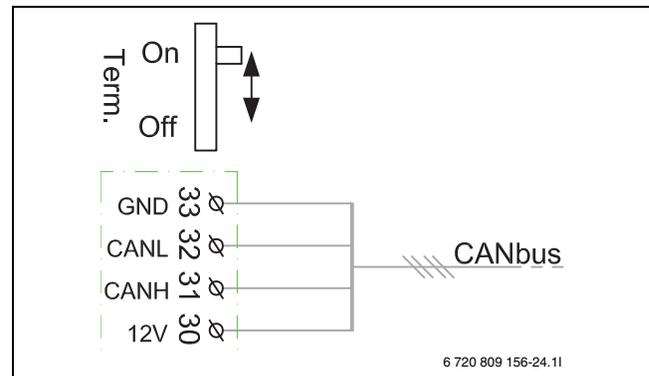
Bild 13 CAN-BUS-Terminierung
