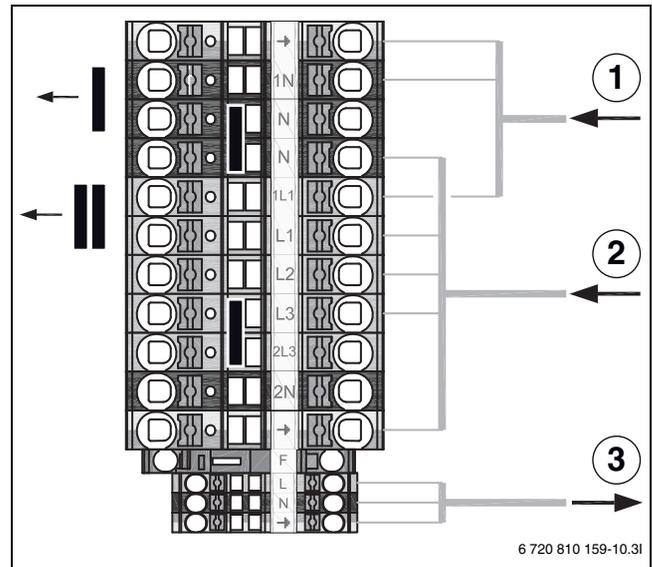
Bild 31 Klemmenanschlüsse und Anordnung der Brücken
