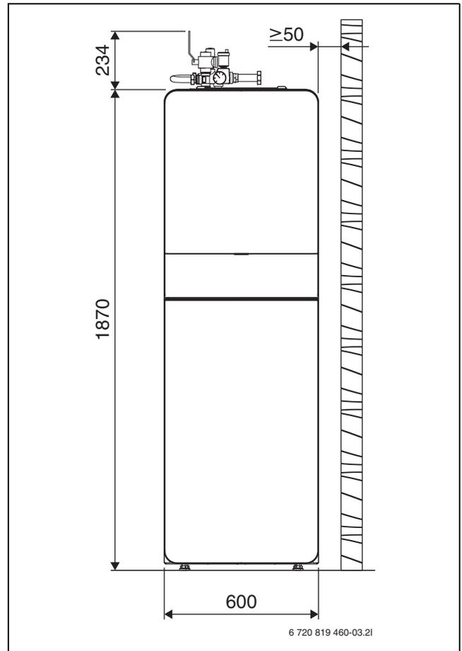
Bild 5 Abmessungen (mm)
