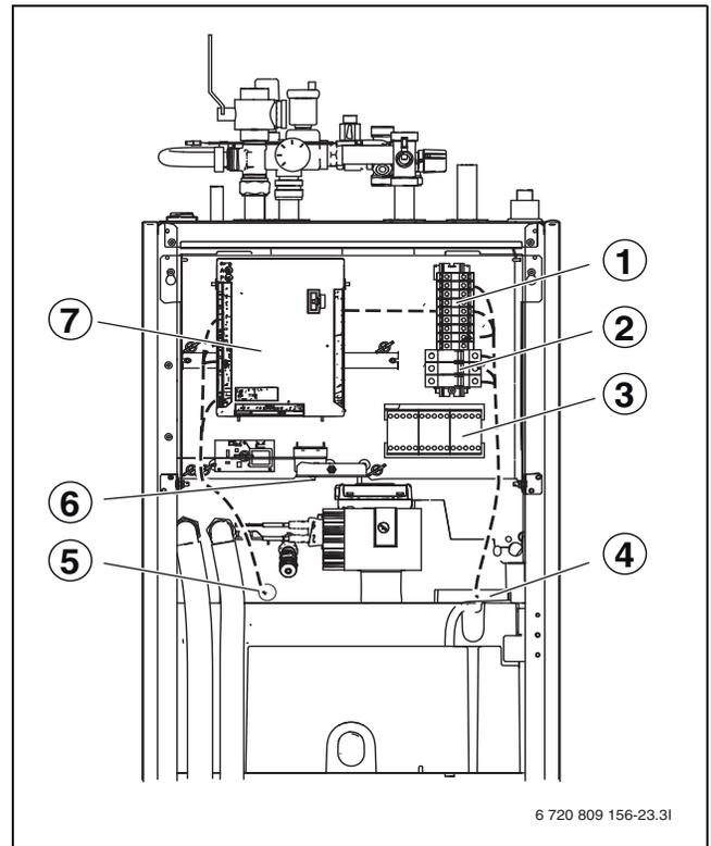
Bild 15 Komponentenordnung im Schaltkasten und Kabelkanäle
