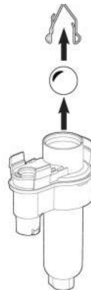
Abb. 81: Sicherungsklammer und Kunststoffkugel des Siphons
