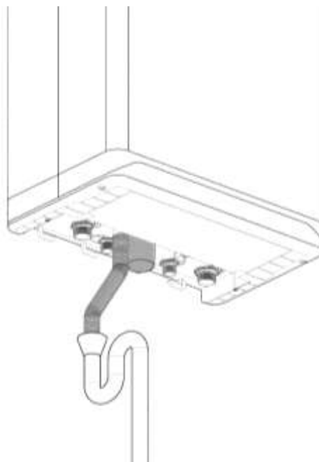
Abb. 9: Frei abtropfender Kondensatablauf
