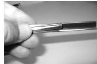
1. Fühler an Außenseite der Fühlerfeder anlegen.
