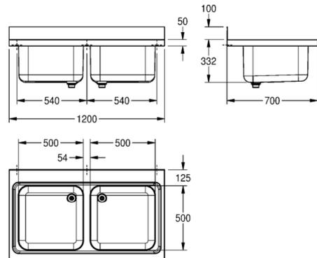
Gewerbespüle, optional montierbar als Auflegespüle (Untergestell) oder für Wandmontage (Konsolen), Chromnickelstahl, Oberfläche seidenmatt, Materialstärke 1,0 mm, 2 fugenlos eingeschweißte Becken, G 1 1/2 B Ventilkörper und 2-teiligem Überlauf-Standrohr, umlaufender Schwallrand, Armaturenbank 100 mm (T), fugenlose Rückwand als Spritzschutz 100 mm (H), inklusive vorgefertigter Befestigungspunkte/ Lochbohrungen für Untergestell / Konsolen.
