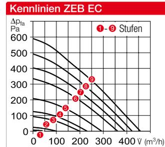
**ZEB mit EC-Technologie** – durch die Ausstattung mit Gleichstrom-Motor wird die EC-Variante der ZEB zur „Energiespar-Lüftungsbox“, die ideal auf den Einsatz im Niedrigenergiehaus ausgelegt ist. Kollektorlose Gleichstrom-Motoren arbeiten mit extrem niedrigem Verlust und somit auch im Regelbetrieb mit höherem Wirkungsgrad als konventionelle Motoren. Daraus ergeben sich überzeugende Vorteile:
